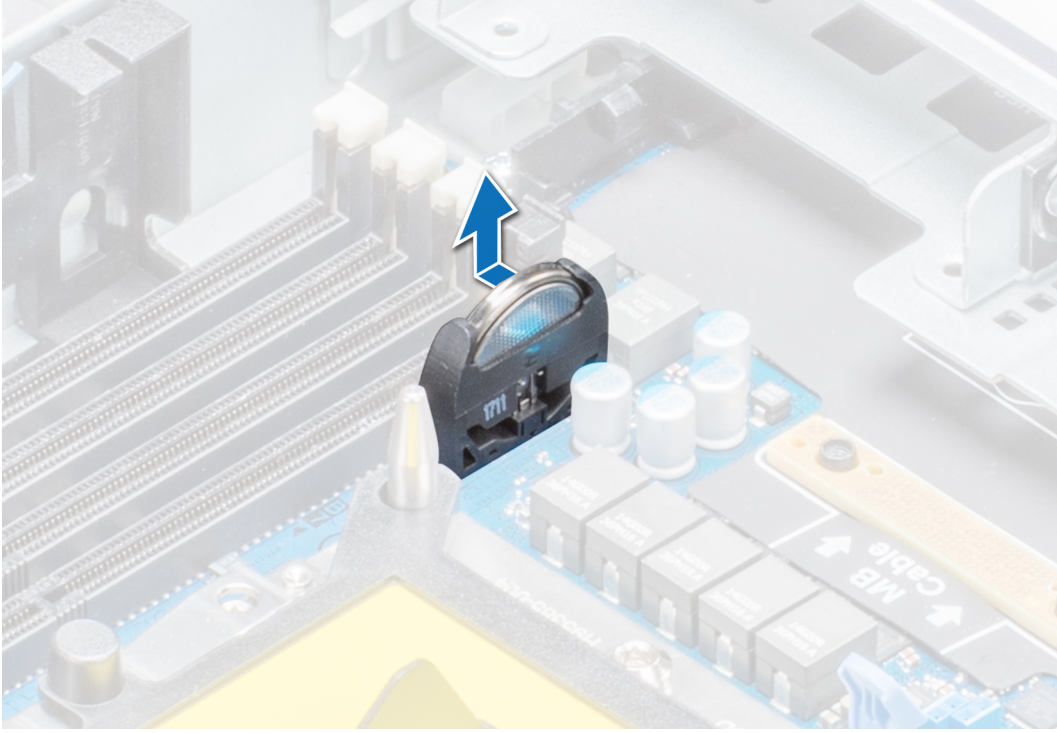
Rakam 48. Sistem pilinin çıkartılması
