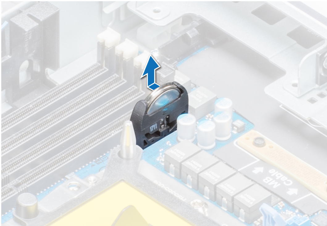
Figure 48. Retrait de la pile du système
