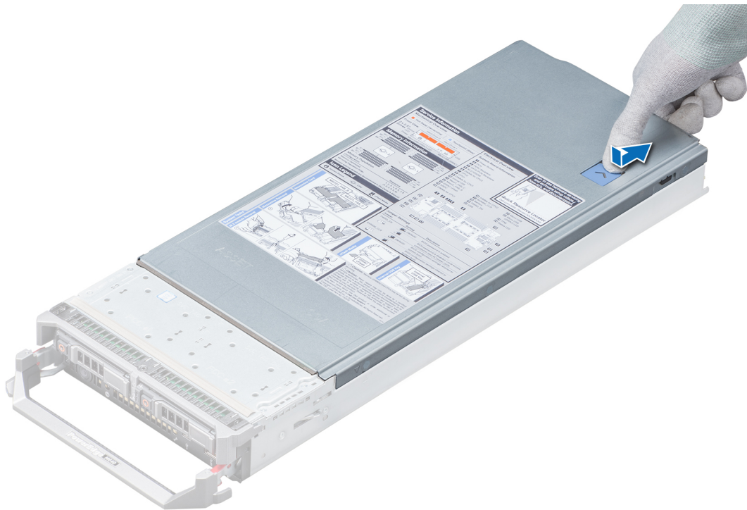
Figure 12. Retrait du capot du système
