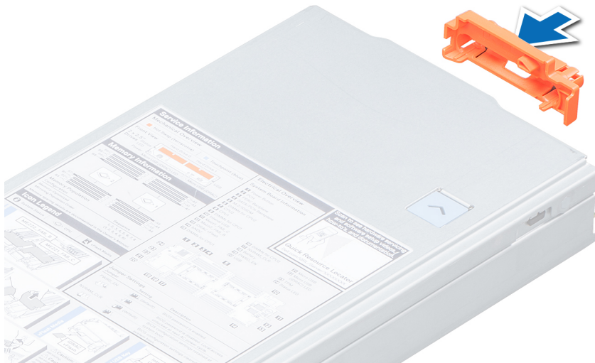
Figure 8. Installation du cache de connecteur d'E/S.
