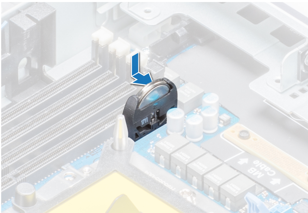
Figure 49. Installation de la pile du système
