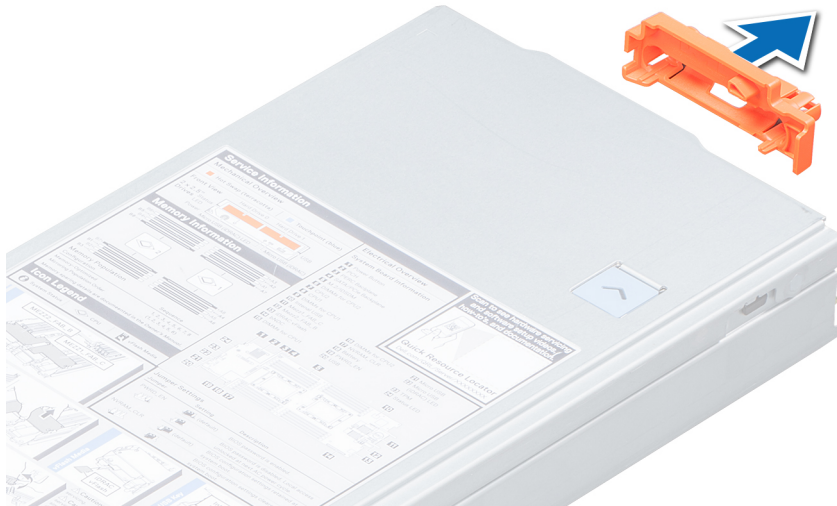
Figure 9. Retrait du cache de connecteur d'E/S.
