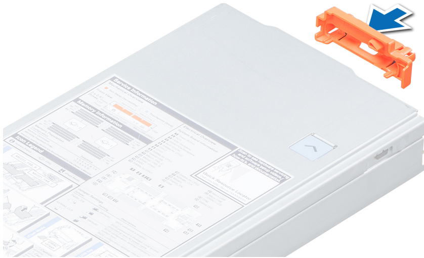
Ilustración 8. Instalación de la cubierta del conector de E/S.
