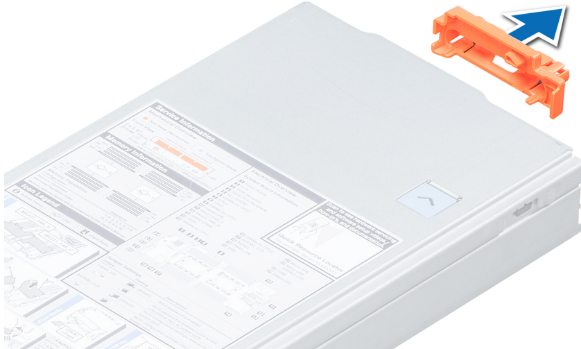
Ilustración 9. Extracción de la cubierta del conector de E/S.
