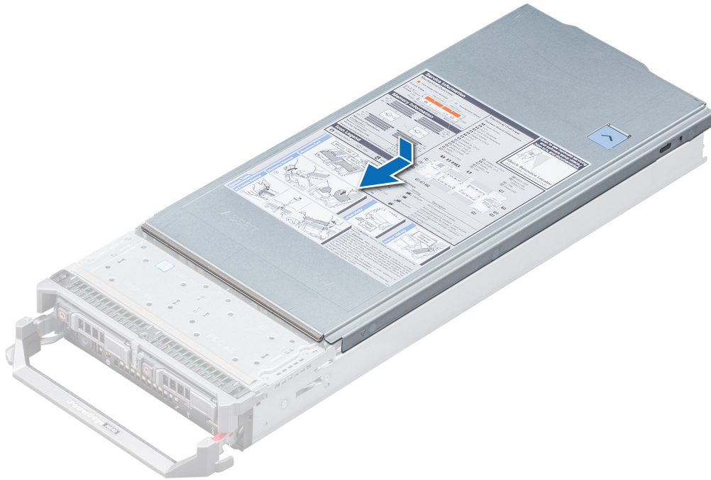
Ilustración 13. Instalación de la cubierta del sistema
