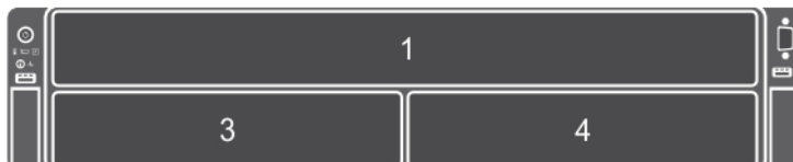
Ilustración 5. Numeración de las ranuras de sled en chasis de tres compartimientos
