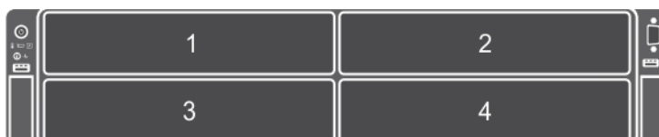
Ilustración 1. Numeración de las ranuras de sled en chasis de cuatro compartimentos
