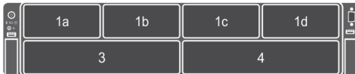
Ilustración 4. Numeración de las ranuras de sled en chasis de seis compartimientos
