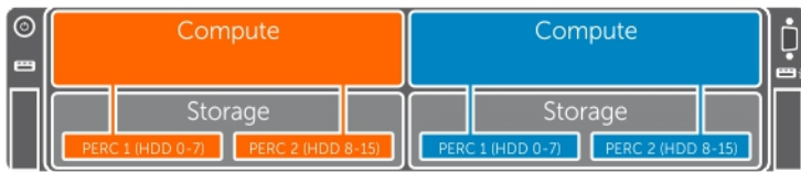
图 9: 拆分单个主机映射配置 — 四托架机箱
