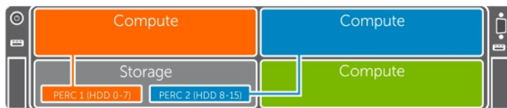
Ilustración 12. Configuración de host doble dividido: chasis de cuatro compartimentos
