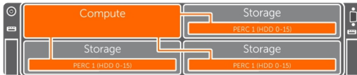
Ilustración 6. Configuración de asignaciones de PERC única/modo unido: chasis de cuatro compartimentos (un sled de cómputo)
