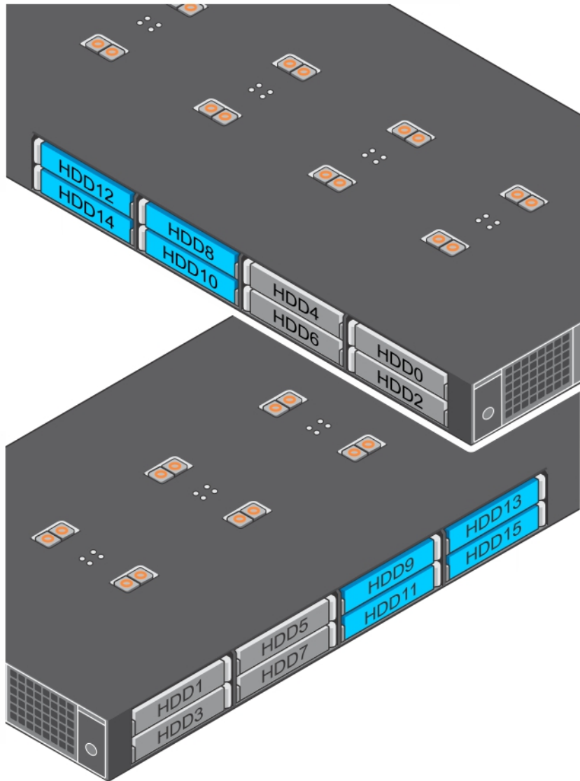
Ilustración 15. Asignación de unidades a controladoras de almacenamiento dobles
