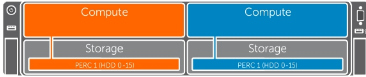
Ilustración 5. Configuración de asignaciones de PERC única/modo unido: chasis de cuatro compartimentos
