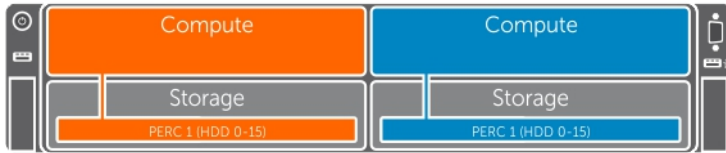
Abbildung 5. Einzelne PERC-/Joined-Modus-Zuordnungskonfiguration – Vier-Schacht-Gehäuse
