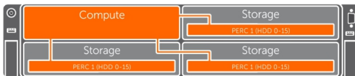
Abbildung 6. Single-PERC-/Joined-Modus-Zuordnungskonfiguration – Vier-Schacht-Gehäuse (ein Rechnerschlitten)
