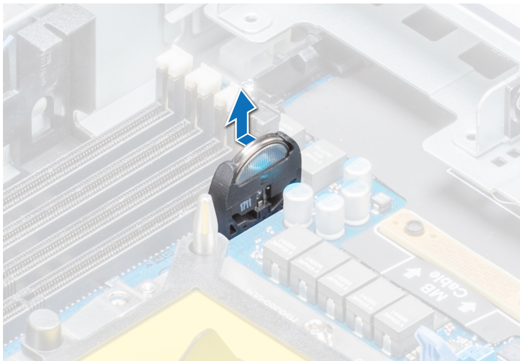
図 48. システムバッテリーの取り外し
