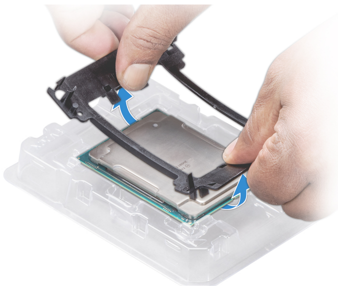
Ilustración 31. Extracción del soporte del procesador
