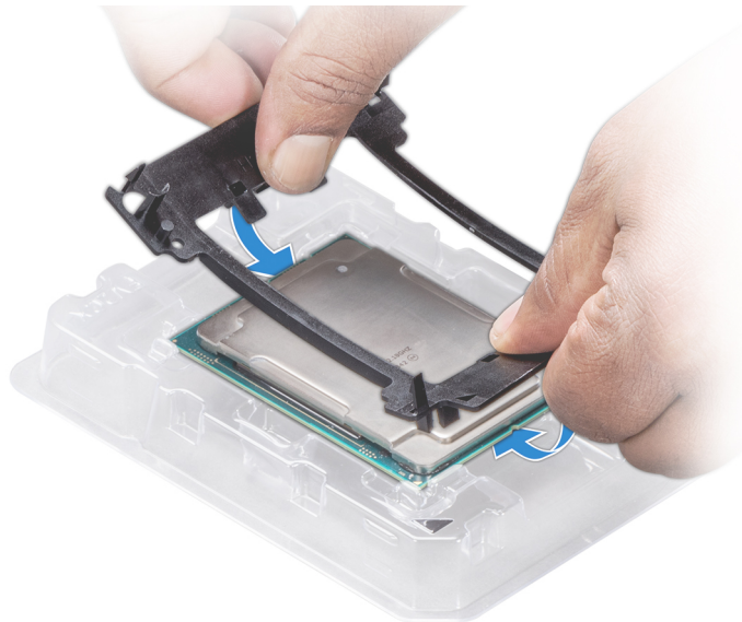
Ilustración 32. Instalación del soporte del procesador
