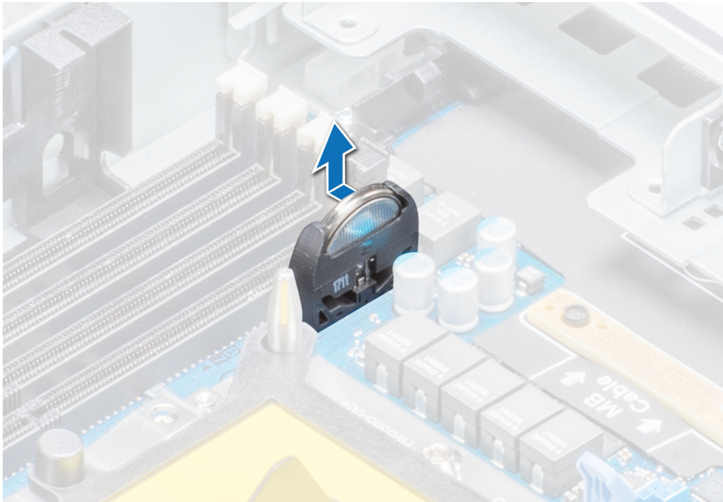
Ilustración 48. Extracción de la batería del sistema
