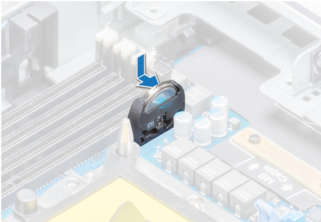
Ilustración 49. Instalación de la batería del sistema
