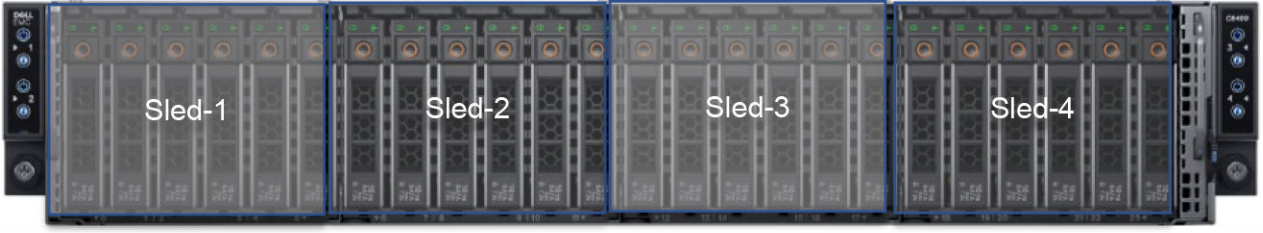
Rakam 8. C6400 kasa - her biri 6 adede kadar SAS/SATA sürücülü dört C6520 kızak ile 24 x 2,5 inç SAS/SATA arka paneli
