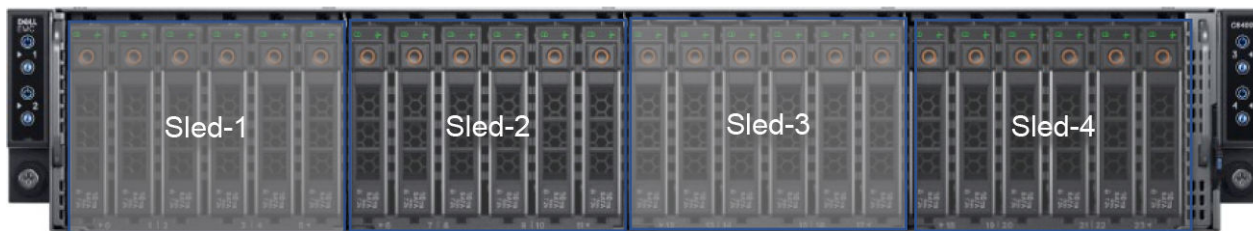
Figure 7. Boîtier C6400 : fond de panier 24 disques NVMe 2,5 pouces avec quatre traîneaux C6520, chacun contenant jusqu'à 6 disques NVMe
