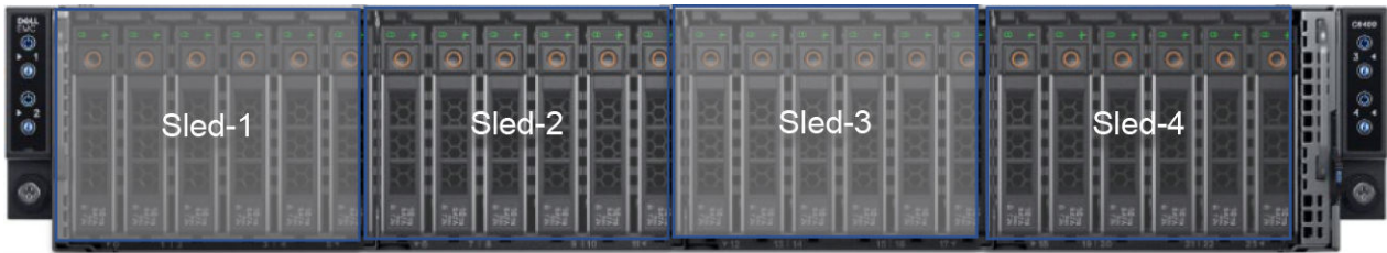
Figure 8. Boîtier C6400 : fond de panier 24 disques SAS/SATA 2,5 pouces avec quatre traîneaux C6520, chacun contenant jusqu'à 6 disques SAS/SATA
