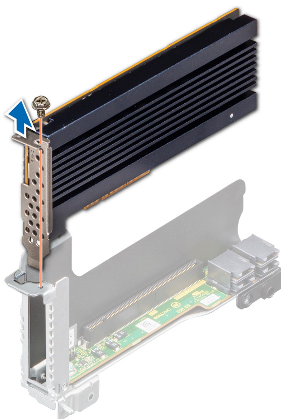
Ilustración 43. Extracción de una tarjeta de expansión del soporte vertical 2
