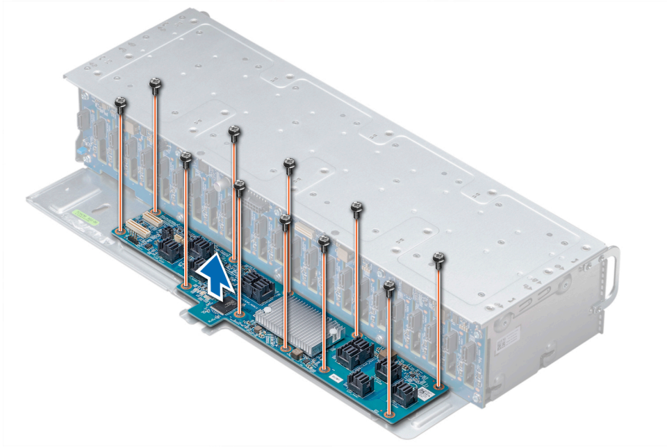
Rakam 69. Arka panel genişletme kartını çıkarma
