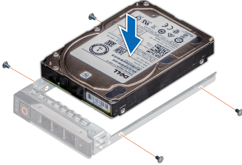
Rakam 28. Sürücüyü sürücü kutusuna takma
