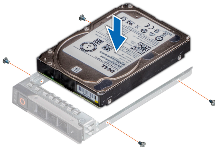
Figure 28. Installation d'un disque dans son support
