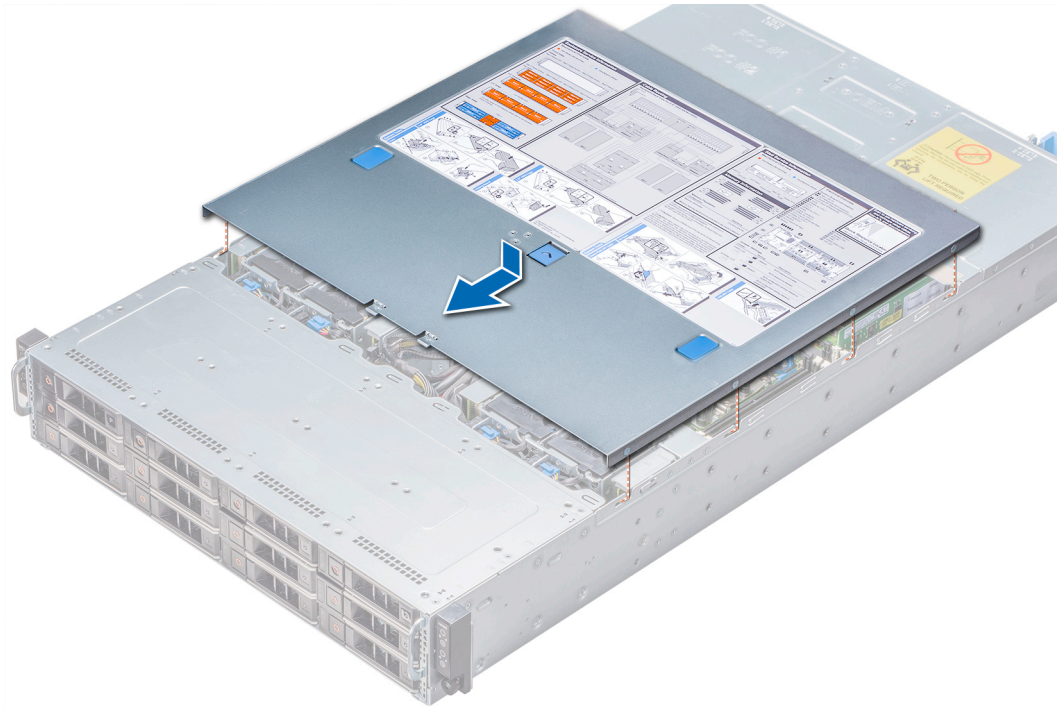
Ilustración 32. Instalación de la cubierta del sistema
