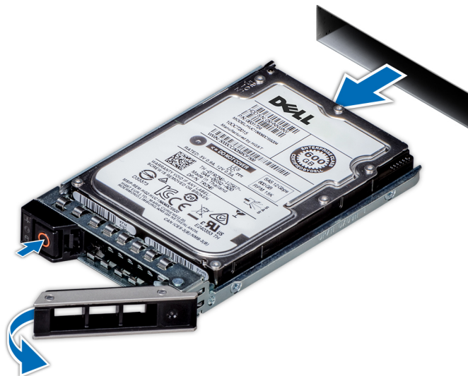
Abbildung 25. Entfernen eines Laufwerkträgers
