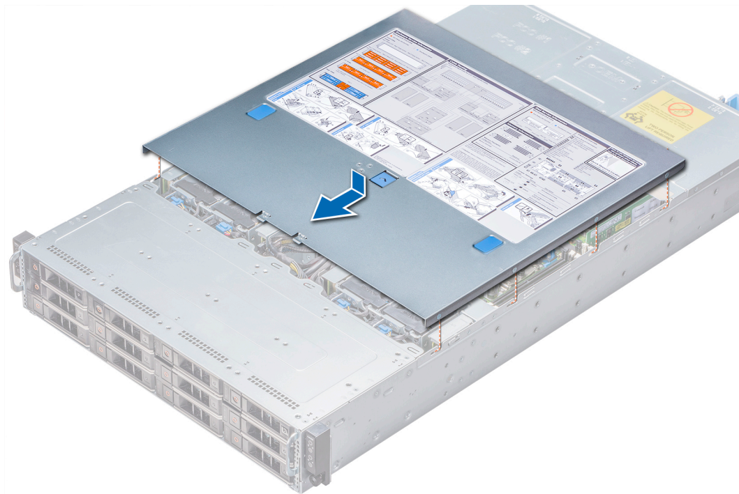
Abbildung 32. Installieren der Systemabdeckung
