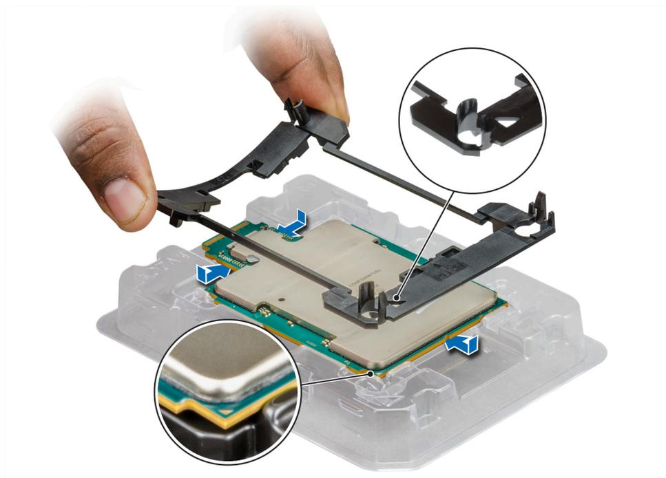
图 45: 安装处理器支架
