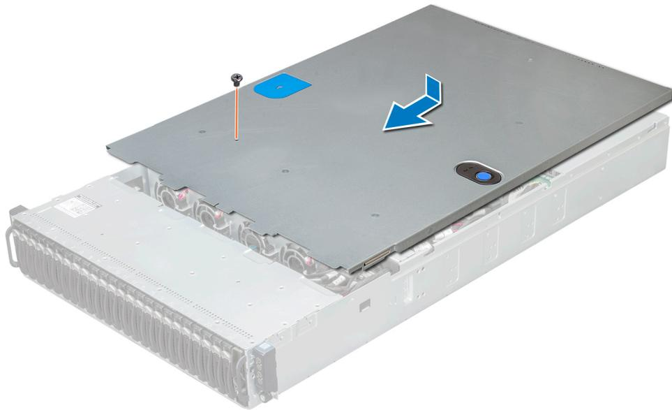
图 87: 安装系统护盖
