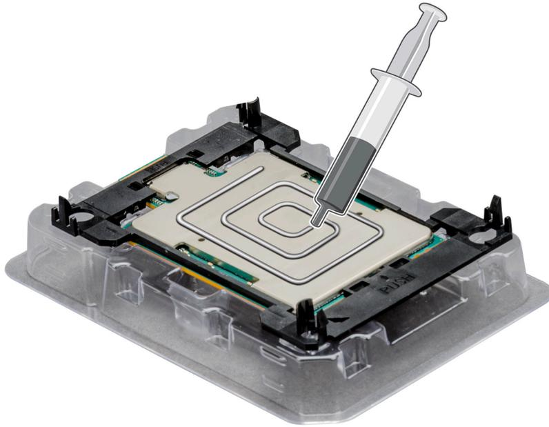
**图 51: 在处理器顶部涂抹导热油脂**
