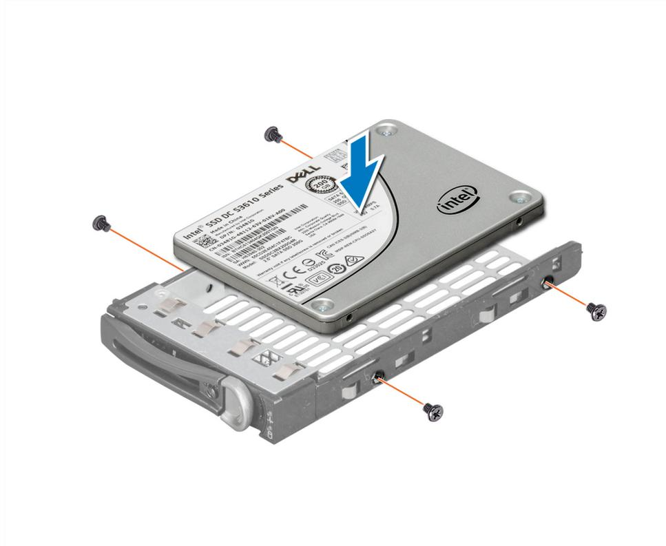
图 83: 将硬盘驱动器安装到硬盘驱动器托盘中
