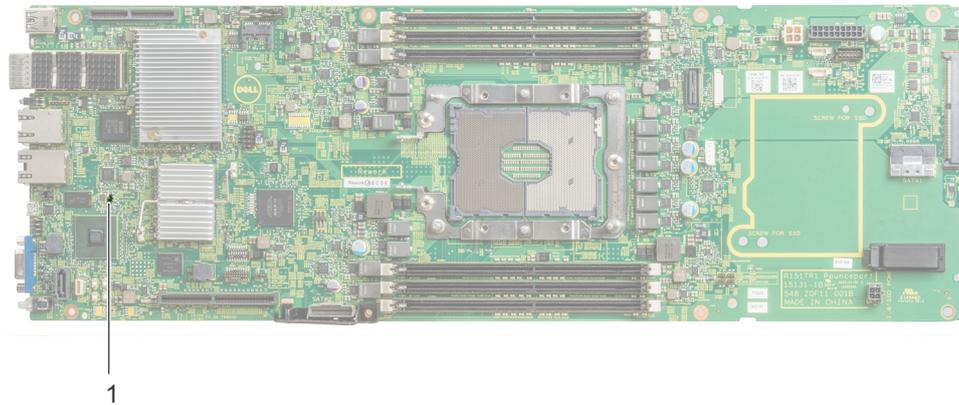
图 13: iDRAC 心跳 LED 指示灯
