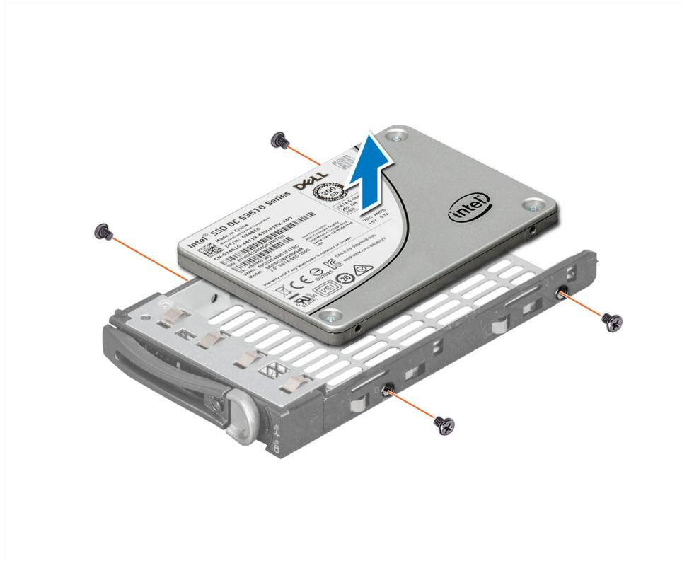
图 82: 从硬盘驱动器托盘中卸下硬盘驱动器
