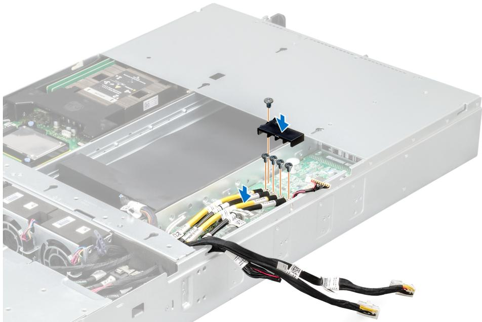
图 101: 安装 PDB 1 的电源电缆和电源电缆护盖
