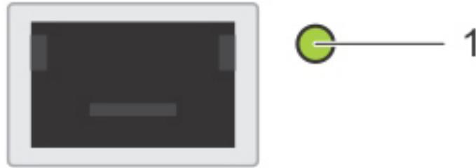
图 8: QSFP 托盘卡上的 LAN 指示灯
