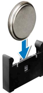
图 74: 安装系统电池 - 固定夹型固定器
