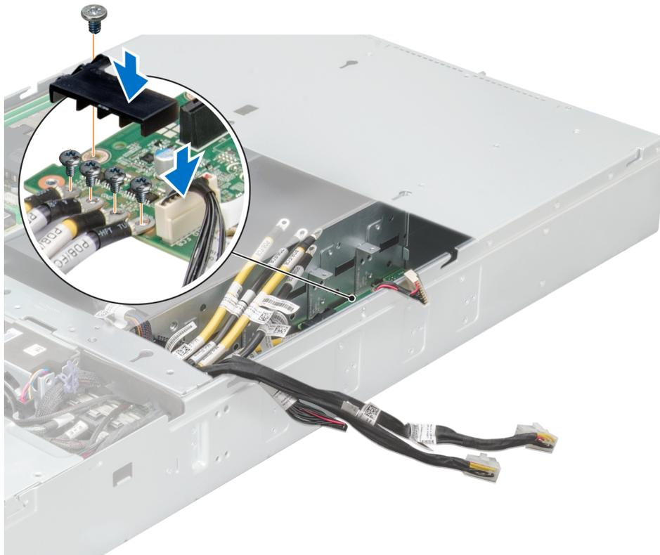
图 98: 安装 PDB 2 的电源电缆和电源电缆护盖
