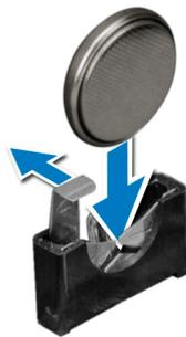
图 72: 安装系统电池
