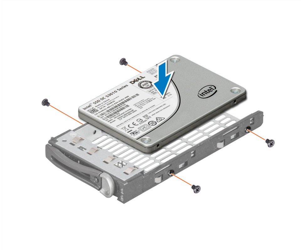
그림 83. 하드 드라이브 캐리어에 하드 드라이브 설치
