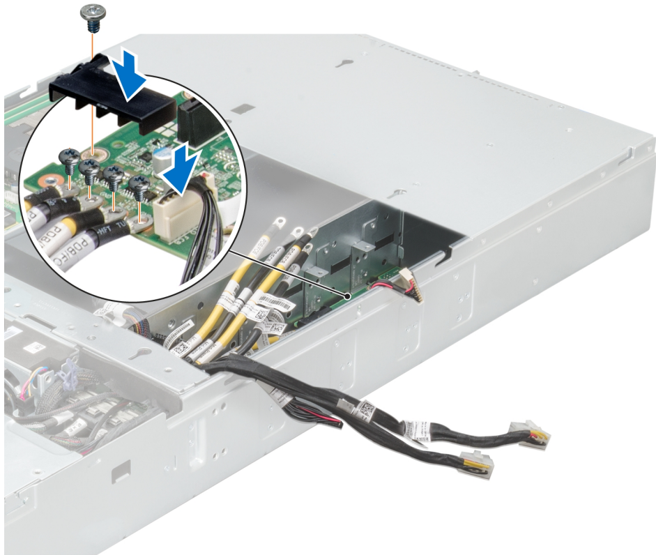
그림 98 . PDB 2용 전원 케이블 및 전원 케이블 덮개 설치
