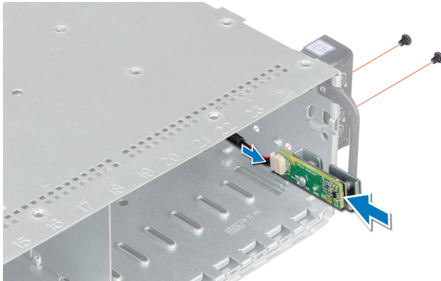
그림 128 . 센서 보드 조립품 설치
