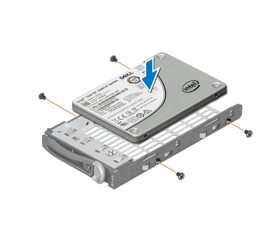
図 83. ハードドライブキャリアへのハードドライブの取り付け
