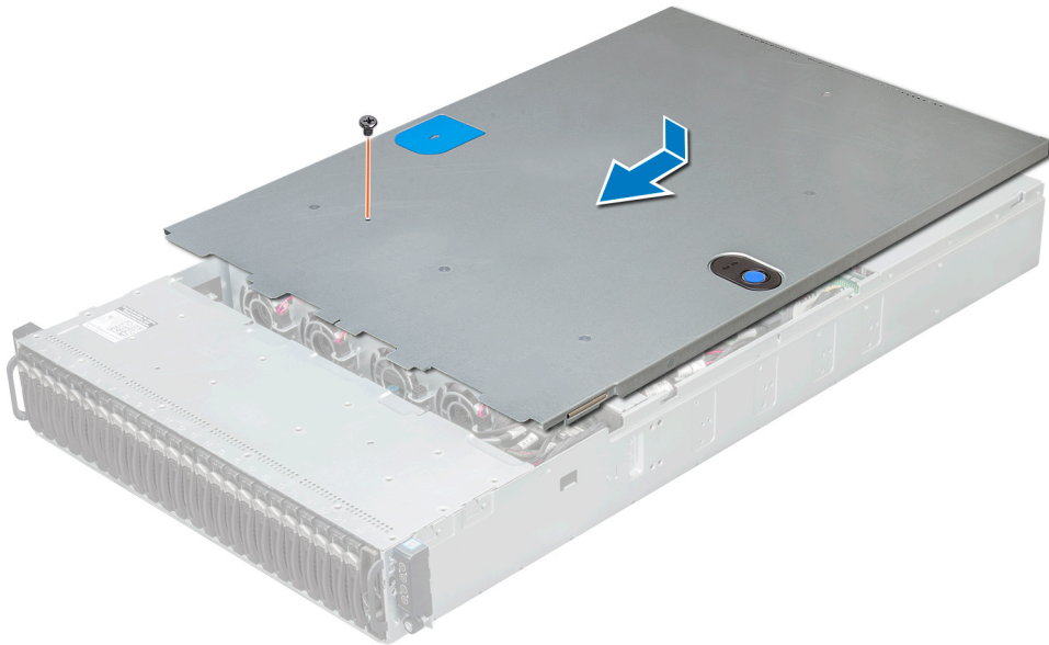
図 87. システムカバーの取り付け
