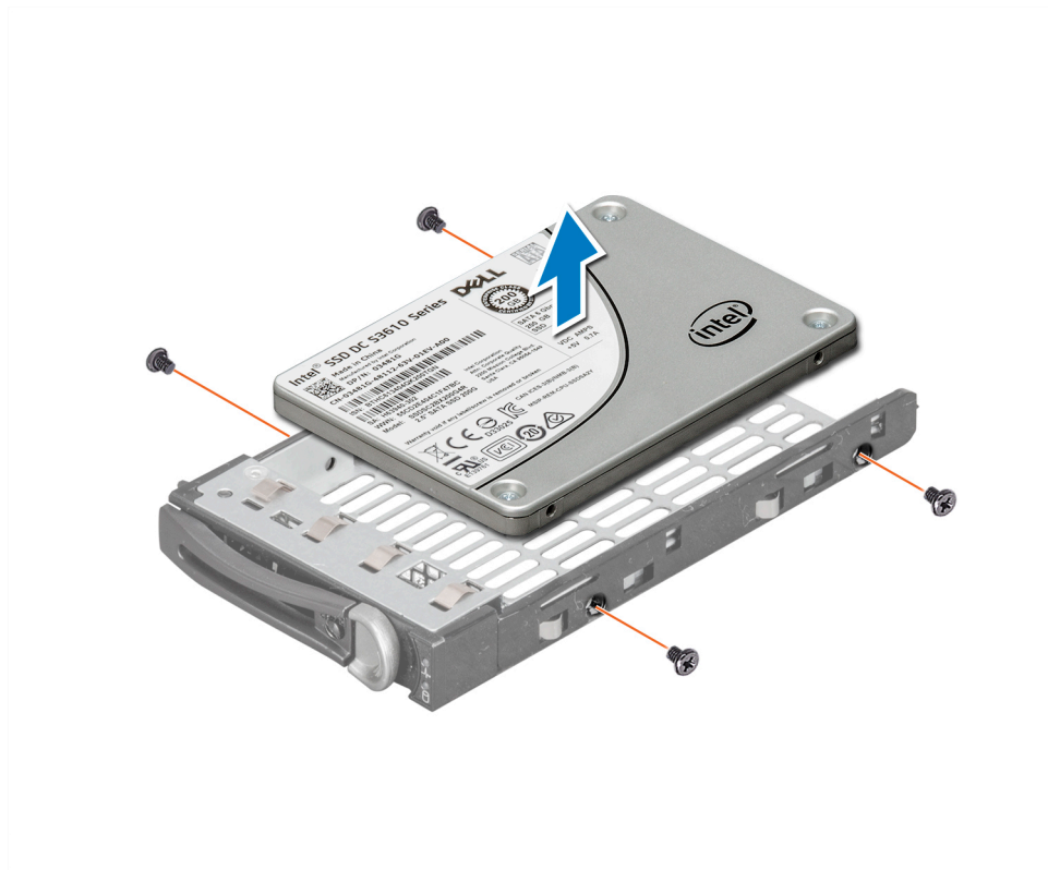
図 82. ハードドライブキャリアからのハードドライブの取り外し
