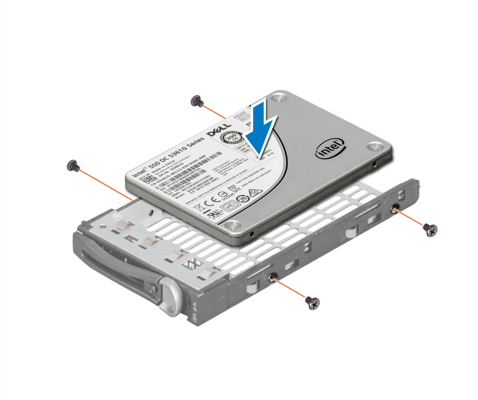
Figure 83. Installation d'un disque dur dans un support de disque dur
