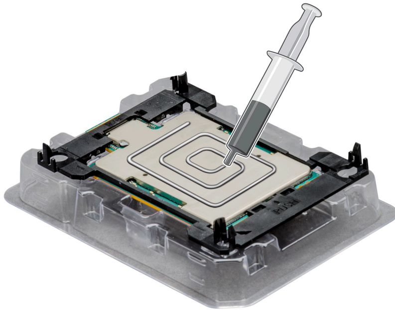
Figure 51. Application de graisse thermique sur la partie supérieure du processeur
