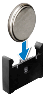
Figure 74. Installation de la batterie du système – Support à pinces
