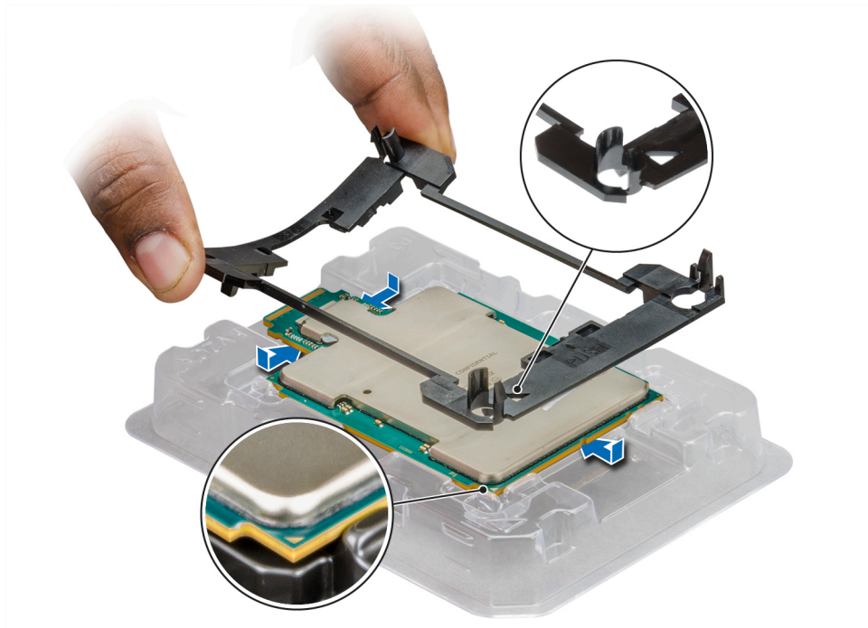
Ilustración 45. Instalación del soporte del procesador
