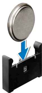
Ilustración 74. Instalación de la batería del sistema: soporte tipo abrazadera
