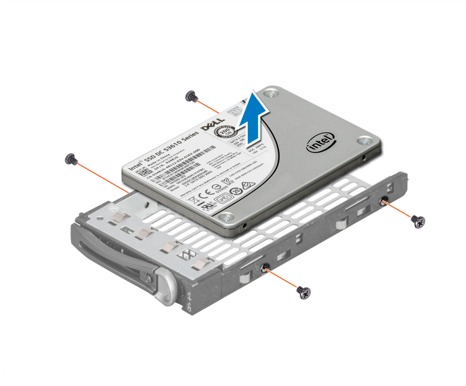
Ilustración 82. Extracción de una unidad de disco duro del portaunidades de disco duro
