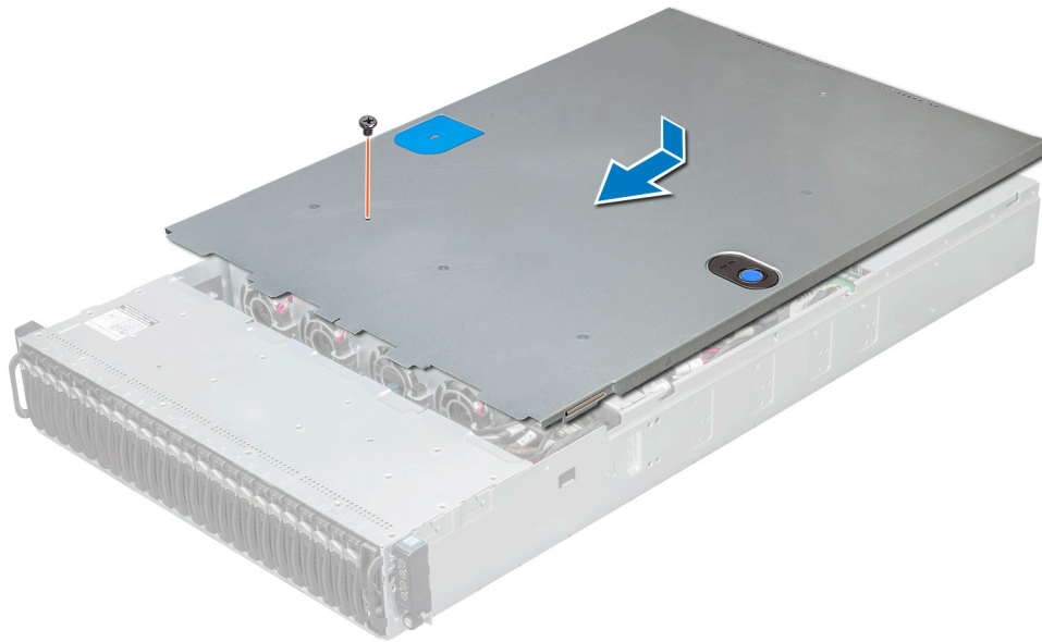
Abbildung 87. Installieren der Systemabdeckung
