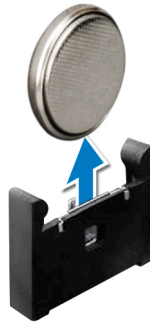
Abbildung 73. Entfernen der Systembatterie aus der Halterung
