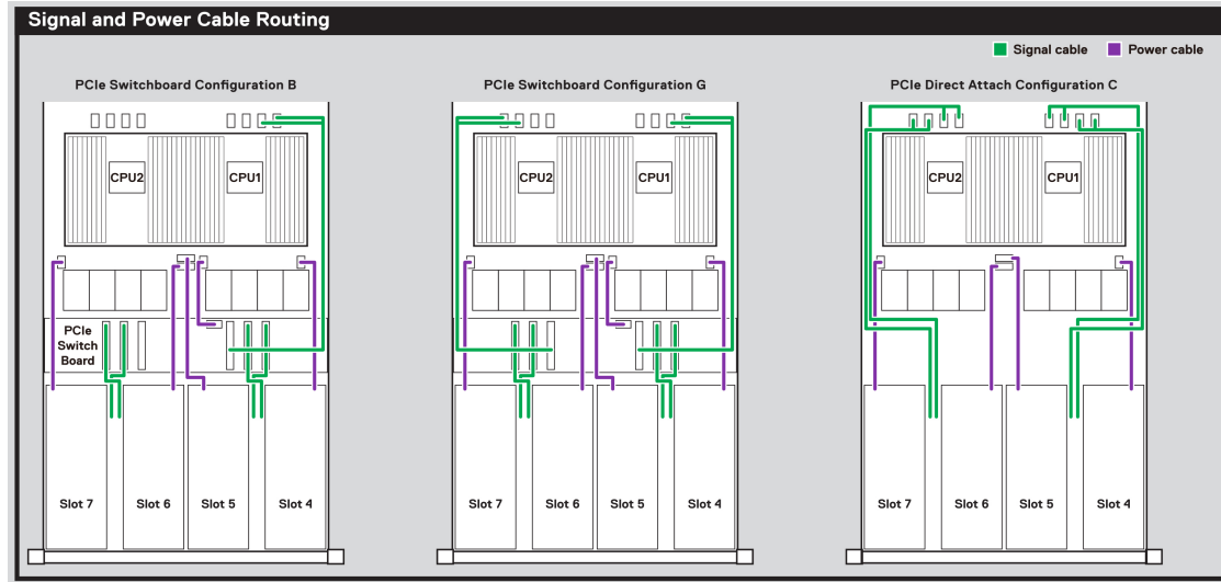
Rakam 19. B, C ve G yapılandırmaları için sinyal ve güç kablosu yönlendirme
