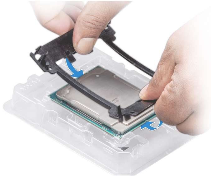
Ilustración 57. Instalación del soporte del procesador
