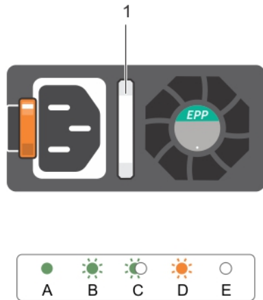
Figure 7. Voyant d'état du bloc d'alimentation CA
