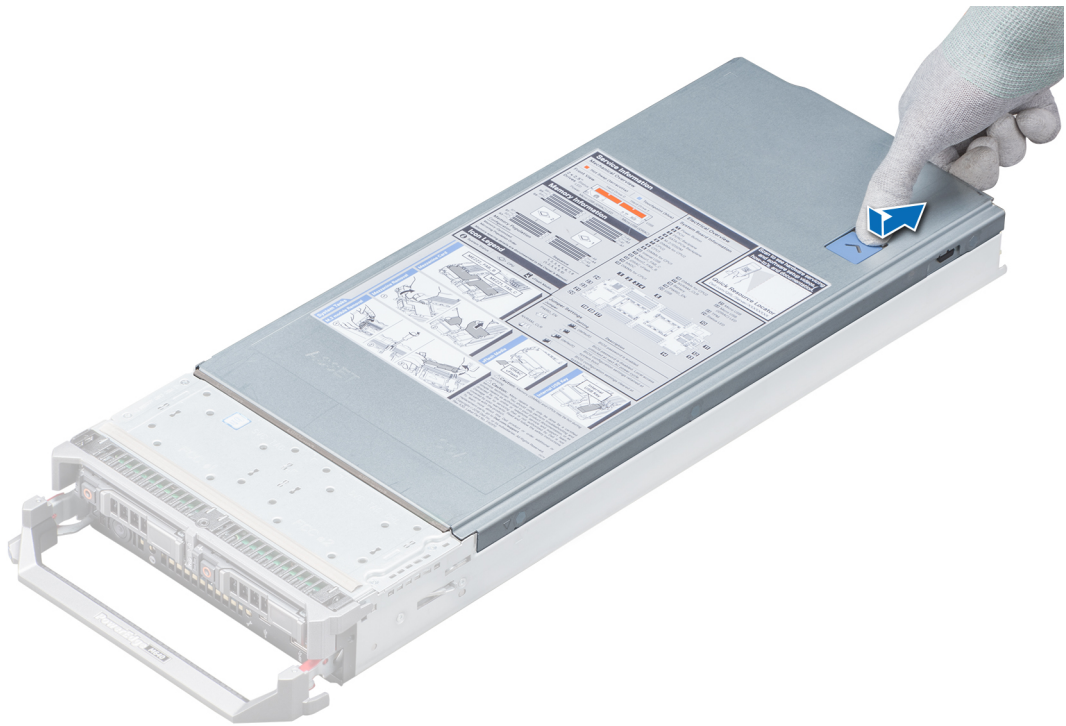
图 12: 卸下系统护盖
