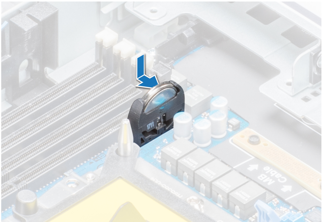
图 47: 安装系统电池
