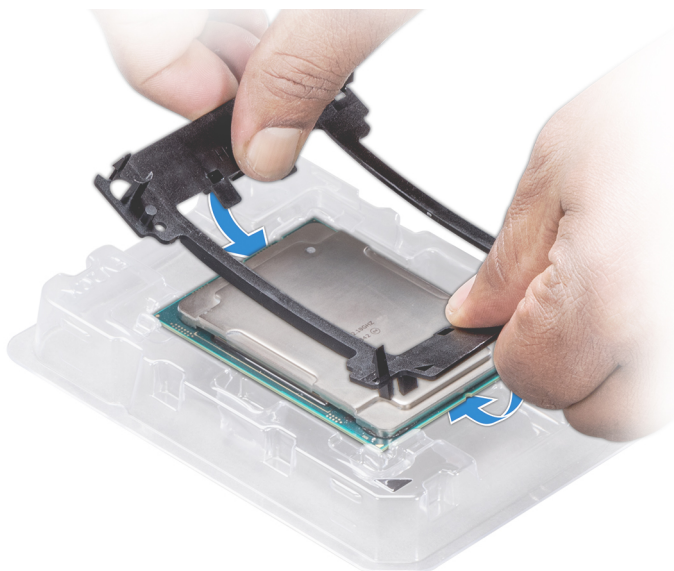
Figure 34. Installation du support de processeur
