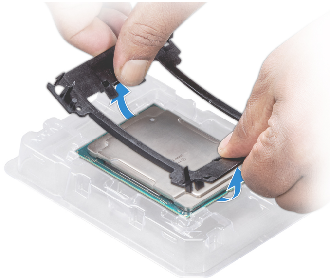
Ilustración 33. Extracción del soporte del procesador
