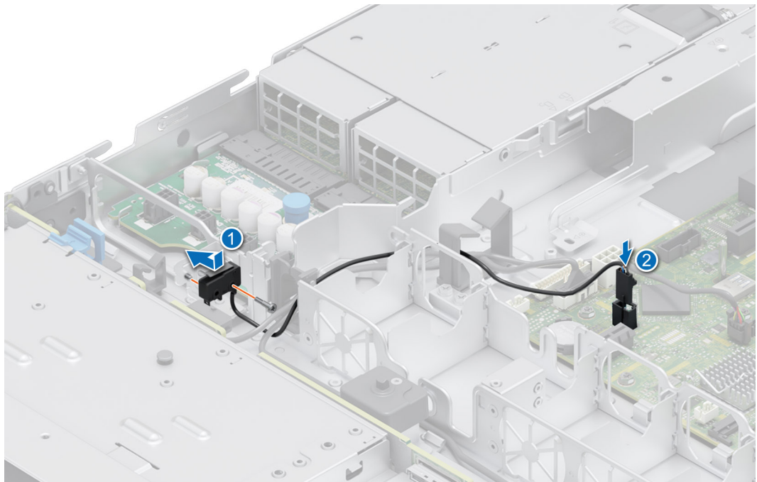
图 18: 安装防盗开关
