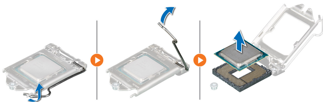
図 43. プロセッサの取り外し
