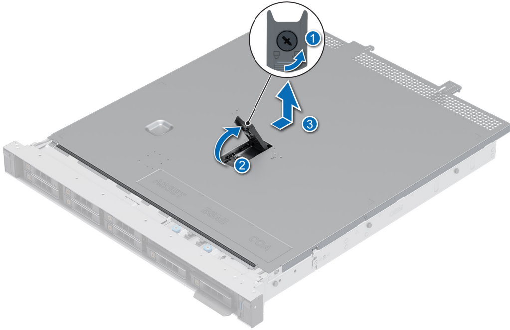
図 11. システムカバーの取り外し
