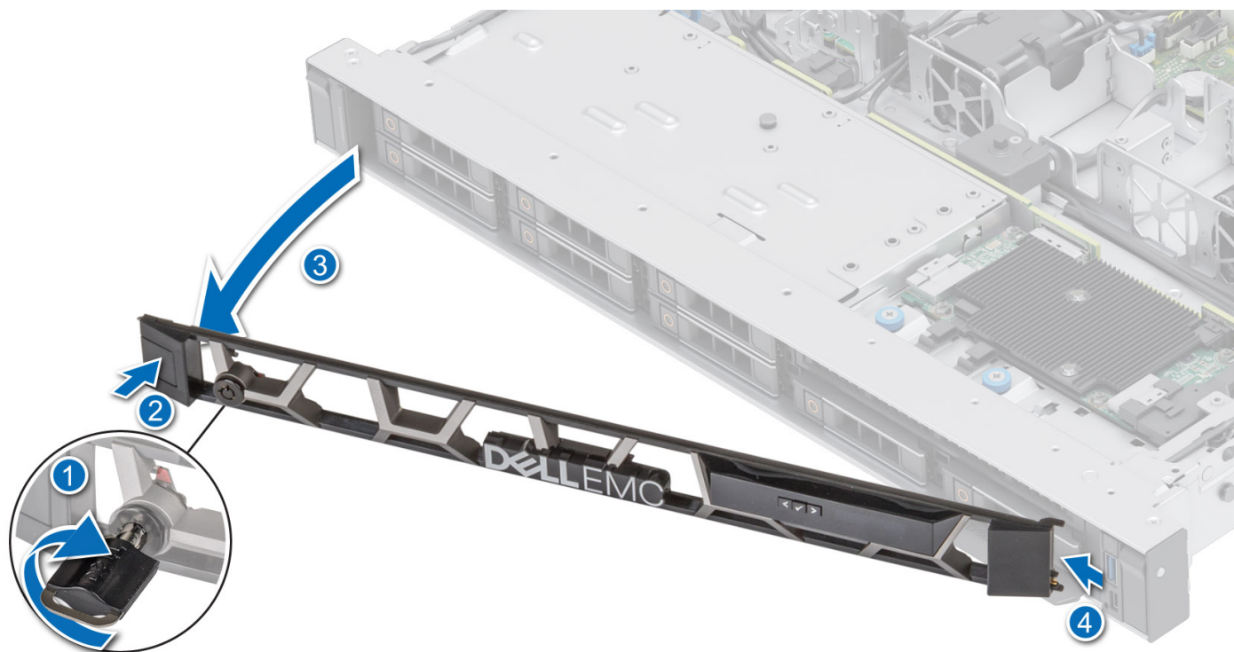
図 9. LCD パネルを持つ前面ベゼルの取り外し
