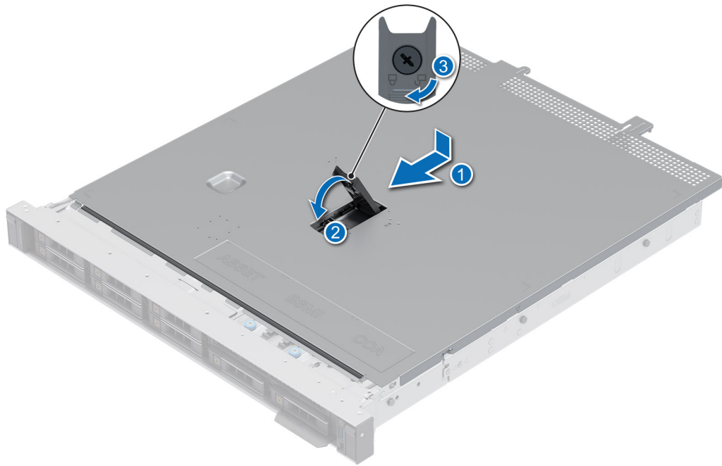
図 12. システムカバーの取り付け
