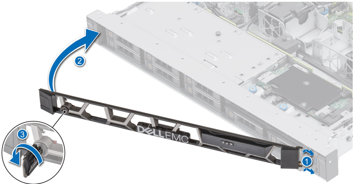
Figure 10. Installation du panneau avant avec l'écran LCD
