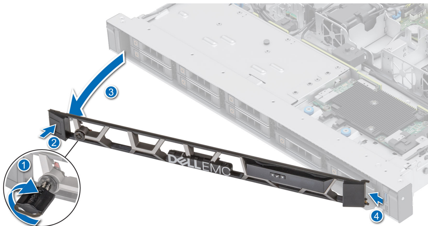
Figure 9. Retrait du panneau avant avec l'écran LCD
