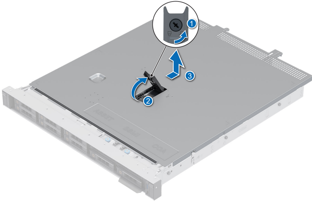
Figure 11. Retrait du capot du système
