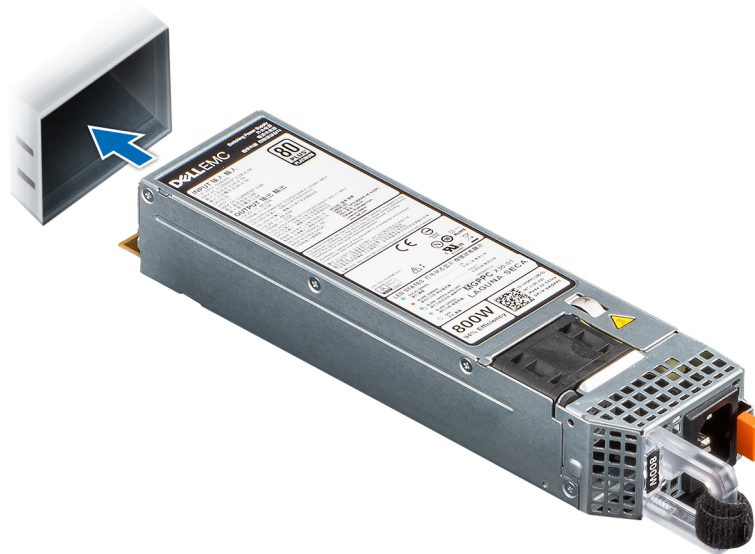
Figure 68. Installation d'un bloc d'alimentation
