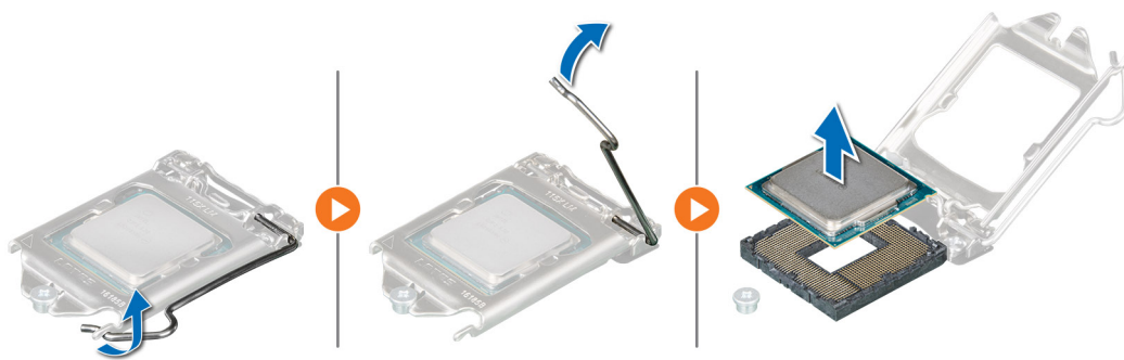
Figure 43. Retrait du processeur
