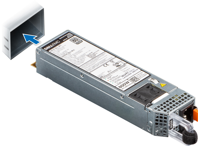
Ilustración 68. Instalación de una fuente de alimentación
