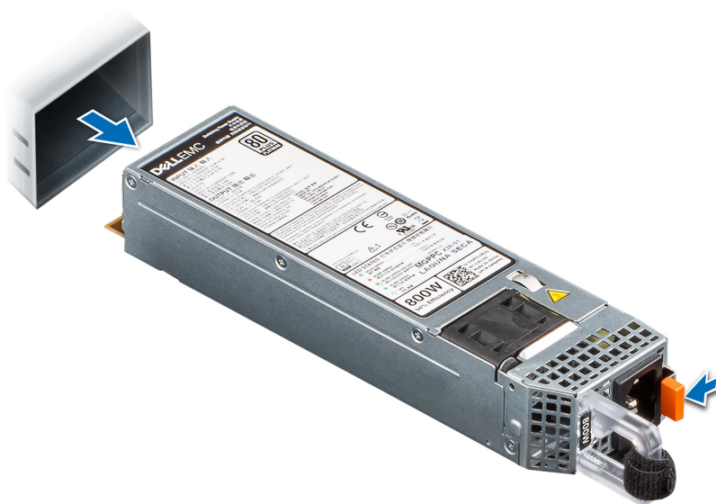
Ilustración 67. Extracción de una fuente de alimentación
