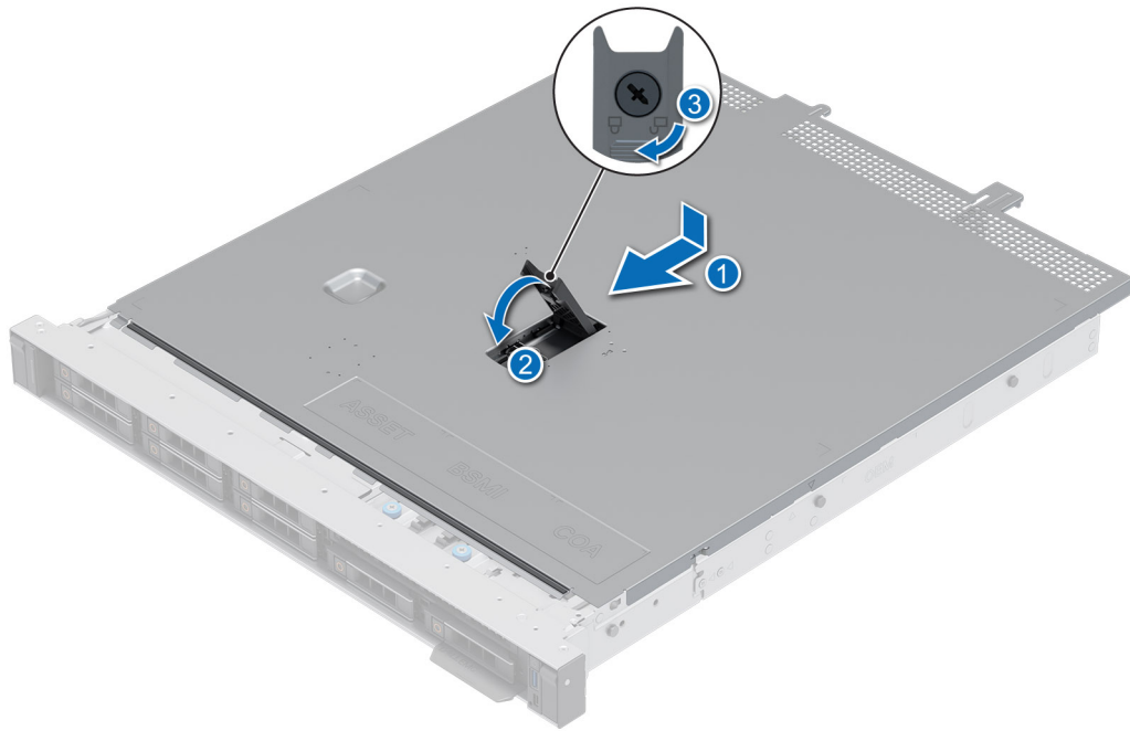
Ilustración 12. Instalación de la cubierta del sistema
