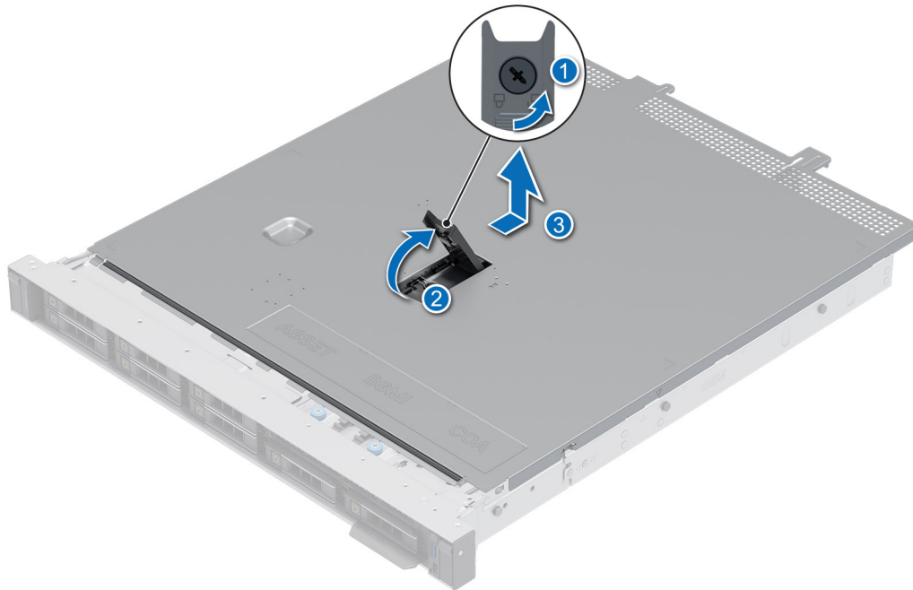
Ilustración 11. Extracción de la cubierta del sistema
