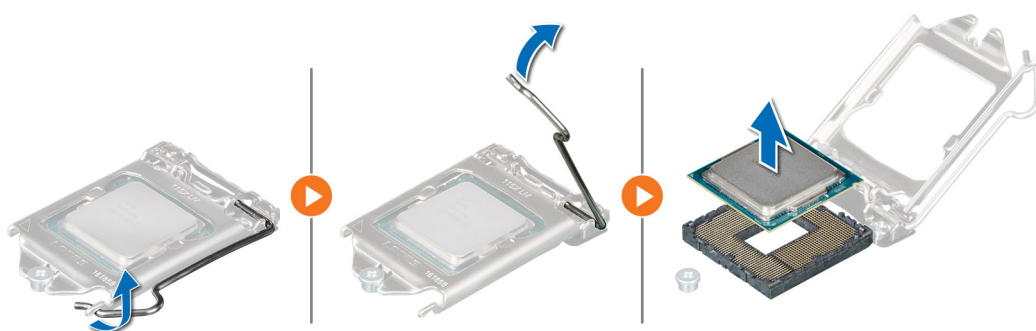
Abbildung 43. Entfernen des Prozessors
