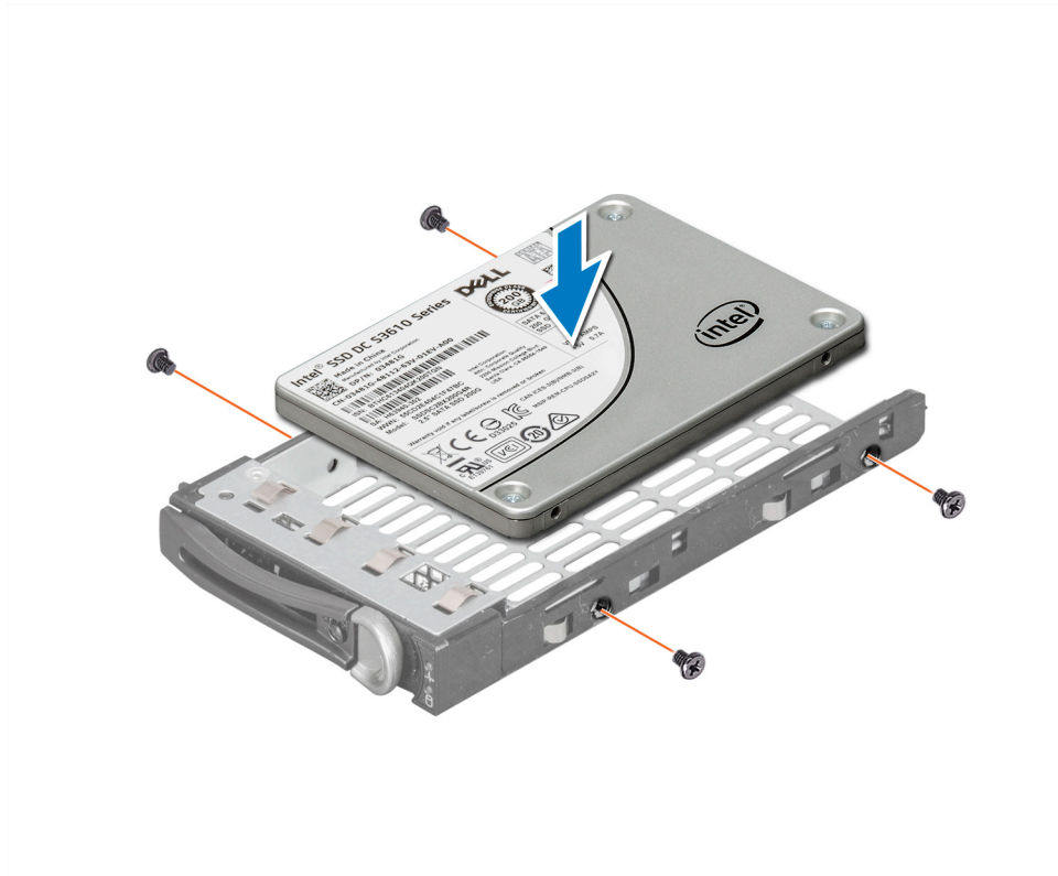
Ilustración 28. Instalación de una unidad de disco duro en un portaunderes de disco duro
