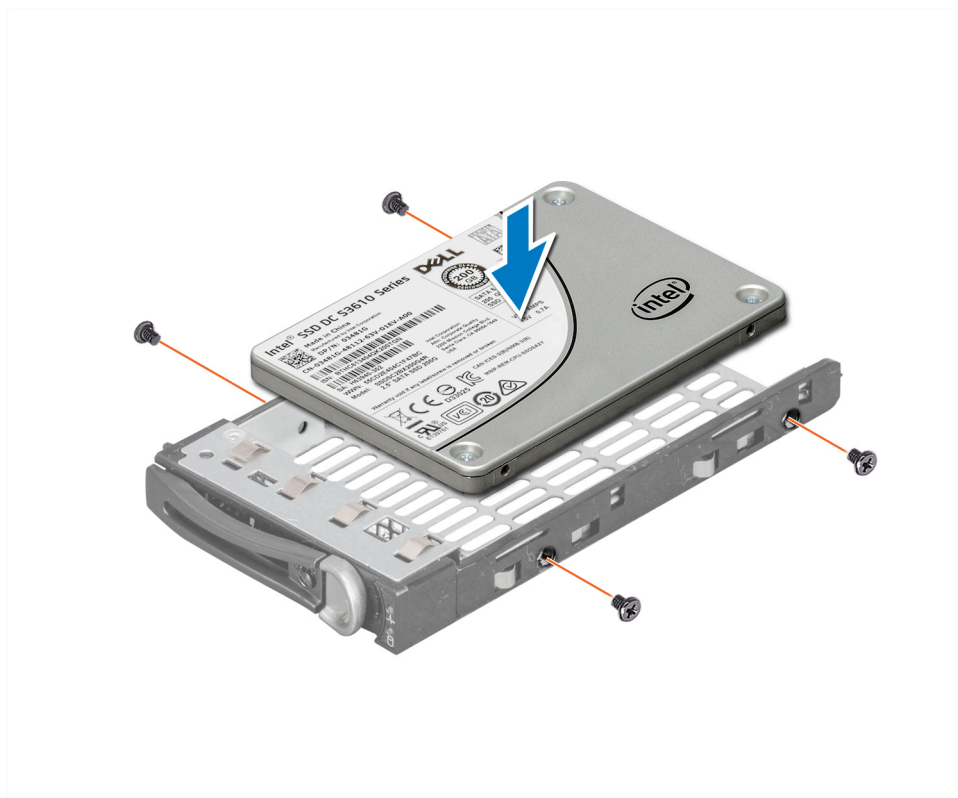
Abbildung 28. Installieren einer Festplatte in einem Laufwerksträger
