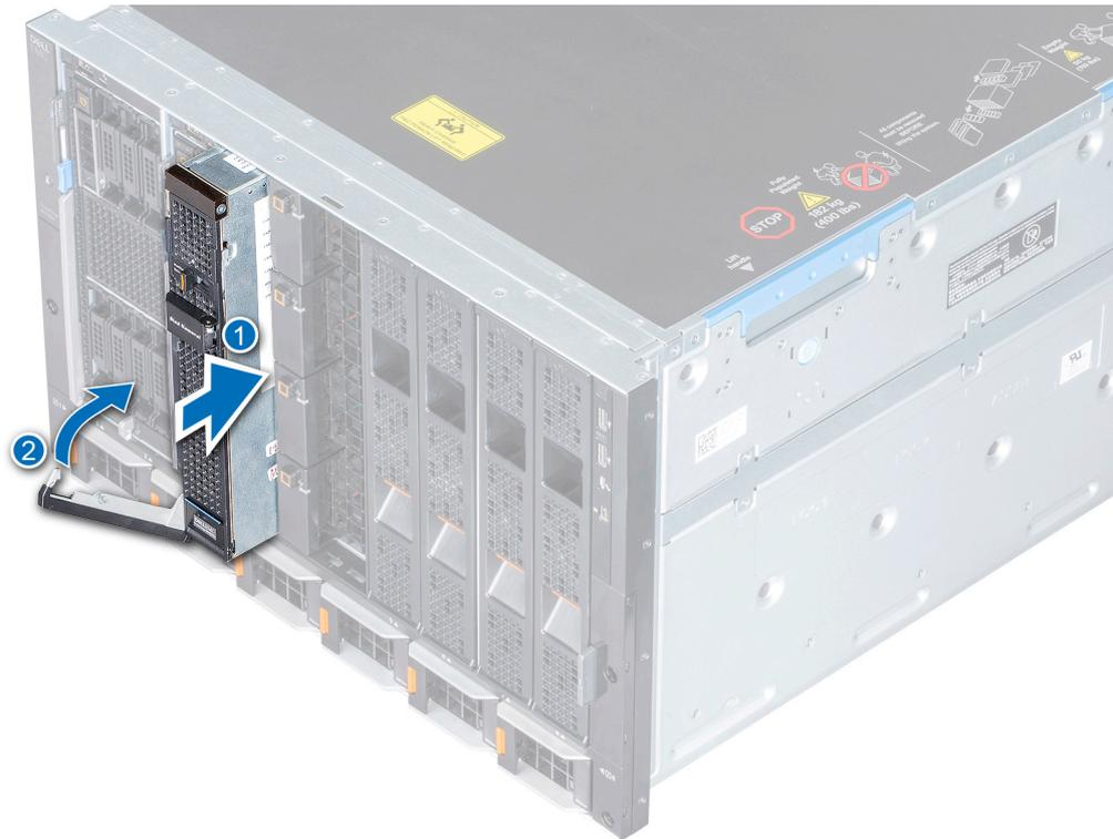
图 9: 在机柜中安装底座
