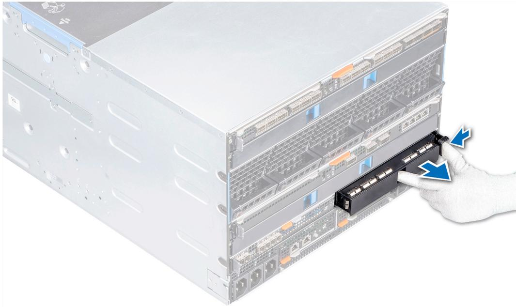
图 22: 从结构 C 插槽卸下挡片
