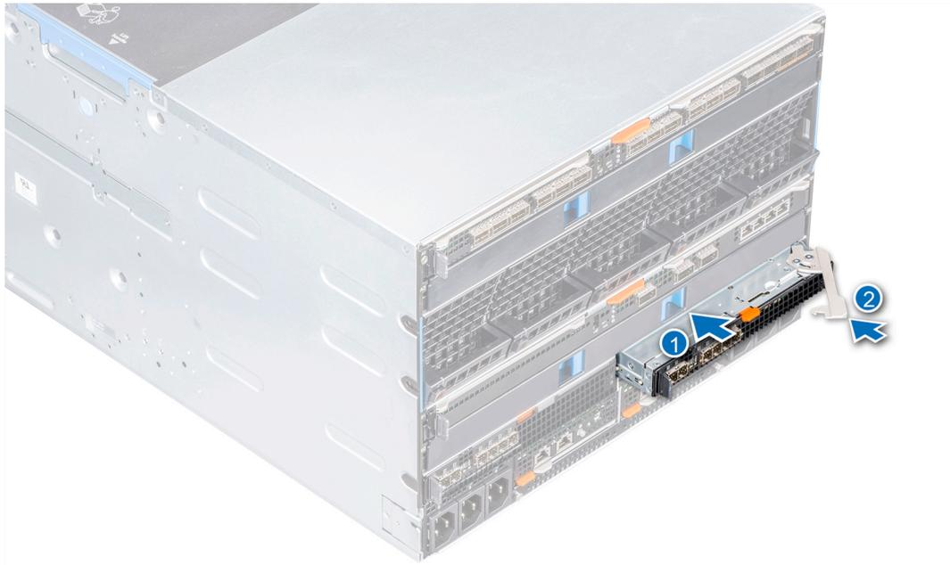
图 25: 在结构 C 插槽中安装 MX5016s 模块
