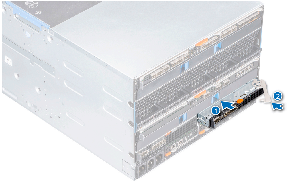
図 25. ファブリック C スロットへの MX5016s モジュール 1 個の取り付け
