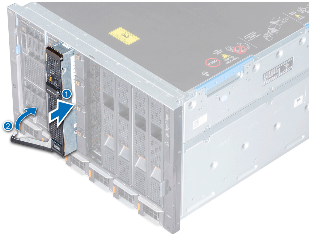
図 9. エンクロージャへのスレッドの取り付け
