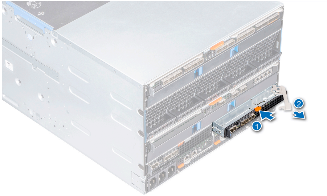
図 24. ファブリック C スロットからの MX5016s モジュール 1 個の取り外し
