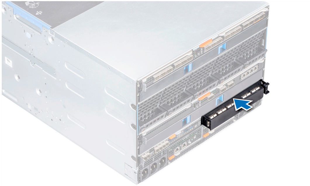
図 23. ファブリック C スロットへのダミー 1 個の取り付け
