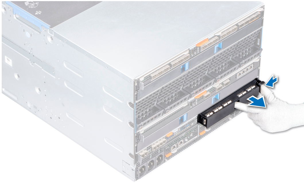
Abbildung 22. Entfernen eines Platzhalters aus dem Fabric-C-Steckplatz
