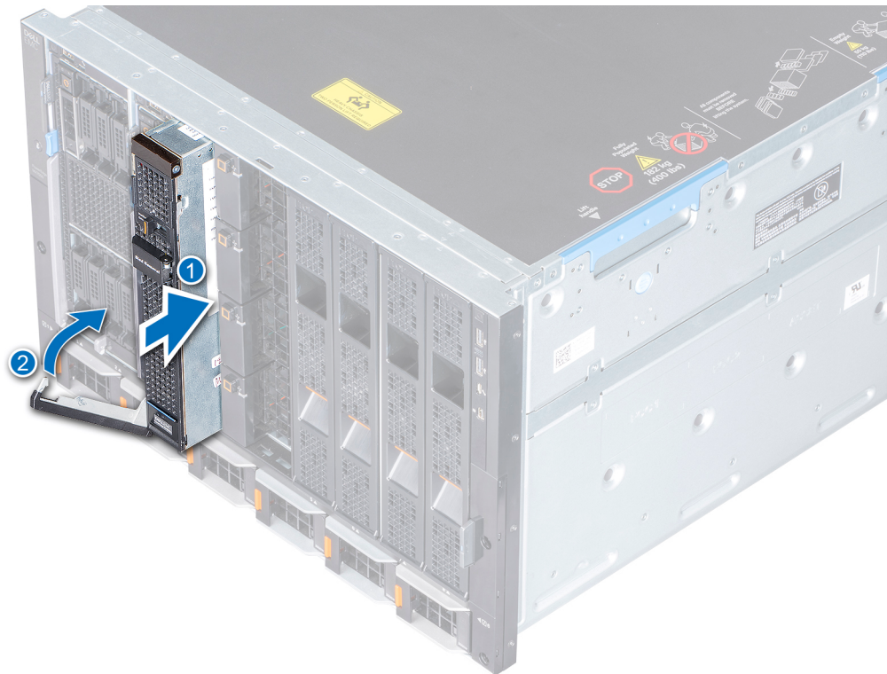
Abbildung 9. Einsetzen des Schlittens in das Gehäuse
