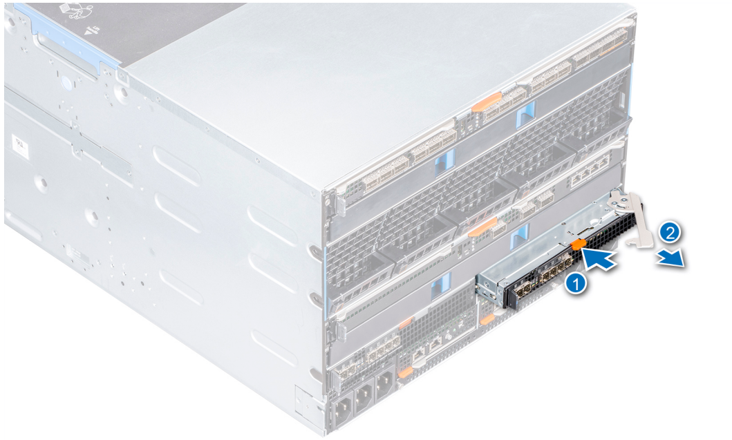
Abbildung 24. Entfernen eines MX5016s-Moduls aus dem Fabric-C-Steckplatz
