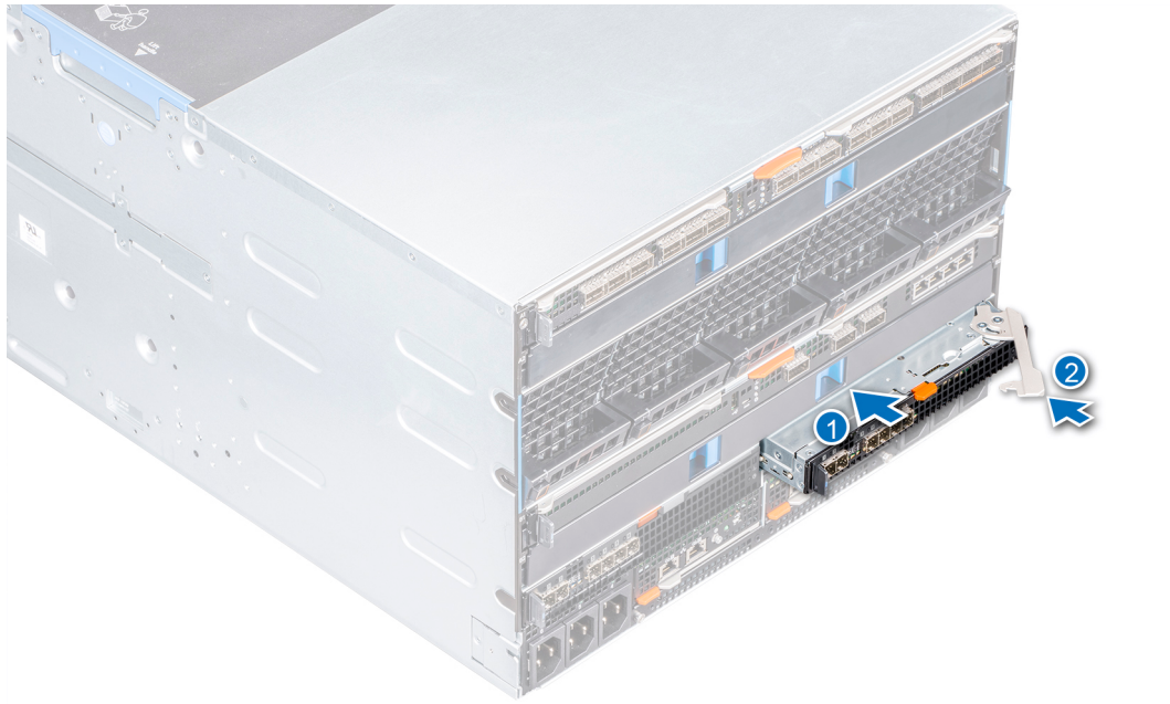
Abbildung 25. Einsetzen eines MX5016s-Moduls in einen Fabric-C-Steckplatz
