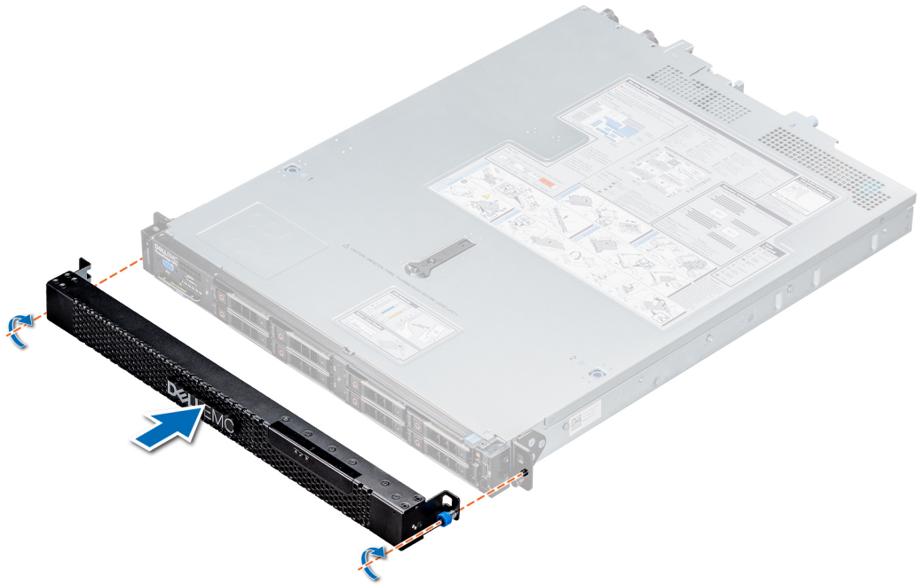
그림 19 . 전면 베젤 설치
