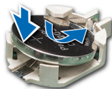
Figure 100. Installation de la pile du système
