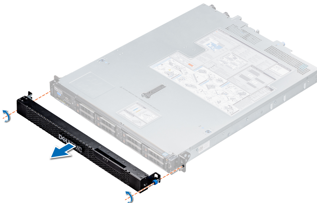
Ilustración 18. Extracción del bisel frontal
