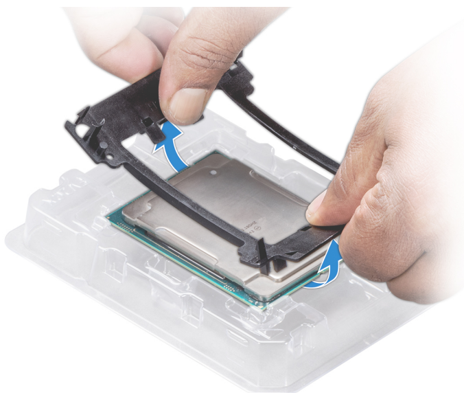
Ilustración 54. Extracción del soporte del procesador
