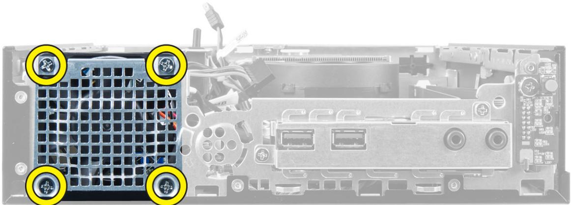
5. Déposez le ventilateur du châssis.
