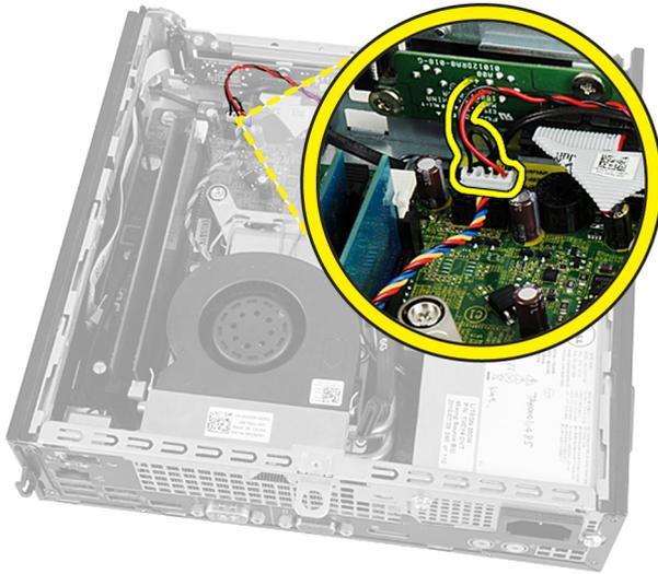
4. Libérez le câble du haut-parleur situé sous le câble du ventilateur du système et le câble d'antenne de réseau sans fil WLAN (le cas échéant).
