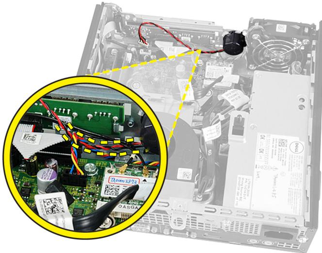
5. Relâchez le loquet et faites pivoter le haut-parleur pour le mettre en position de déverrouillage.
