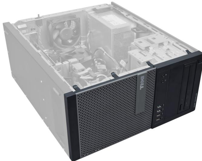
3. 將前面板固定夾從前面板緣的機箱輕輕撬開。
