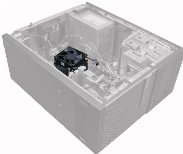
3. 壓下塑膠固定夾以鬆開並從主機板拔下散熱器纜線。
