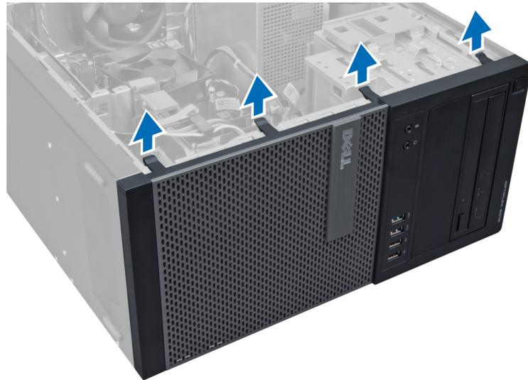
4. 向遠離電腦的方向旋轉前面板，以從機箱釋放前面板另一側邊緣上的掛鉤。
