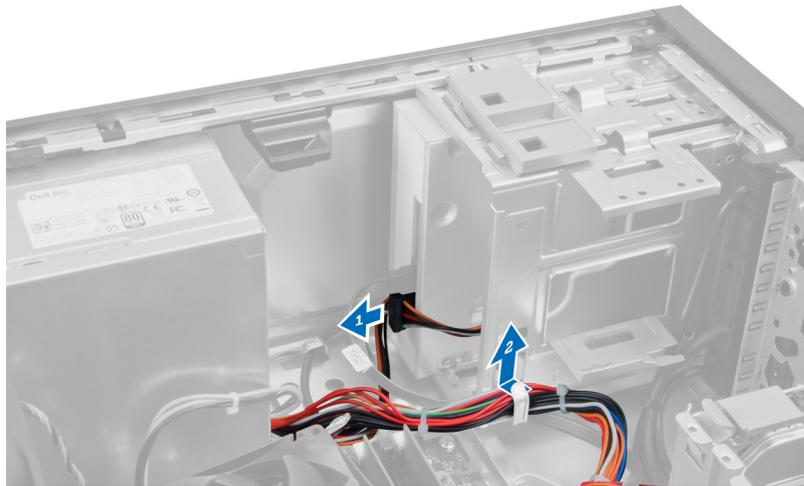
4. 拔下硬碟機的電源線，然後將它從固定夾鬆開。從主機板拔下 24 插腳纜線。
