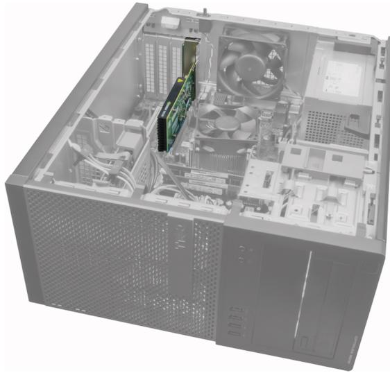
3. 壓下側面的插卡固定門鎖，將門鎖朝另一側向外拉動。
