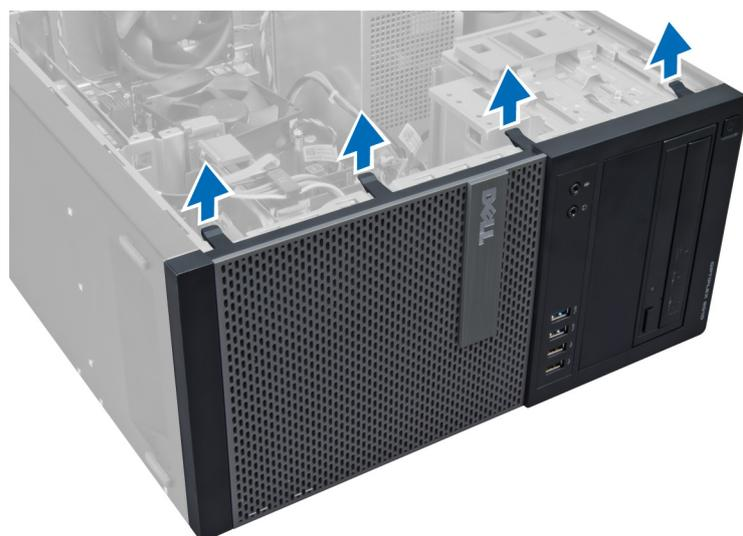
4. 朝远离计算机的方向转动前面板，以松开机箱中面板另一侧边缘上的挂钩。
