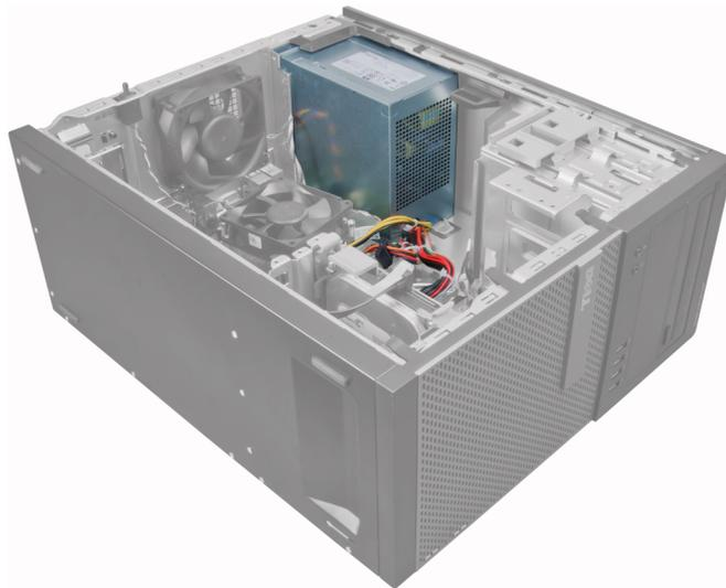
3. 松开并断开电源电缆与光驱的连接。
