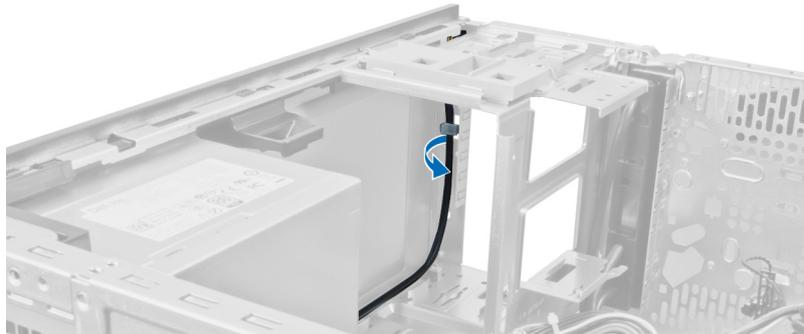
5. 按下电源开关两侧的固定夹，将其从机箱中松开，然后将电源开关拉出计算机。
