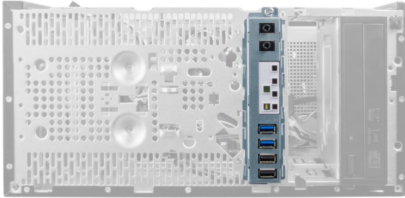
4. 断开 I/O 面板和 FlyWire 电缆与系统板的连接。
