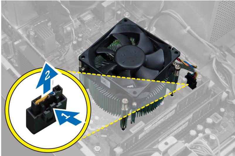
4. 使用梅花槽螺丝刀按对角线顺序拧松系紧螺钉，然后将散热器从计算机中抬起。
