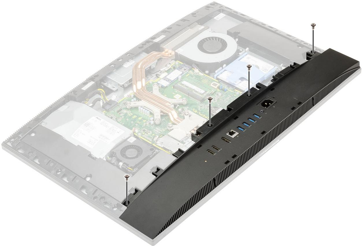
4. Retire e levante a tampa da base da estrutura central.
