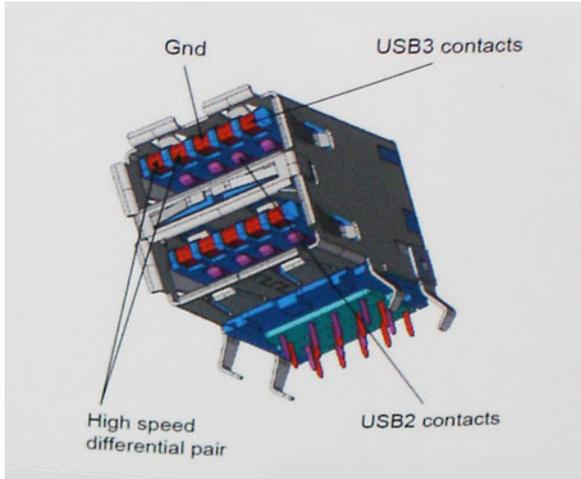
오늘날 고화질 비디오 콘텐츠의 데이터 전송, 테라바이트 스토리지 장치, 고등급 메가픽셀 디지털 카메라 등에 대한 기대가 점점 높아짐에 따라, USB 2.0의 속도는 충분하지 않을 수 있습니다. 게다가 USB 2.0을 연결할 경우 실제 최대 데이터 전송 속도는 320Mbps(40MB/s)로, 이론상 최대 처리량인 480Mbps에 결코 근접할 수 없습니다. 마찬가지로 USB 3.0/USB 3.1 Gen 1 연결 역시 4.8Gbps에 도달할 수 없습니다. 현실적인 최대 전송 속도는 최대 400MB/s로 볼 수 있을 것입니다. 이 속도에서 USB 3.0/USB 3.1 Gen 1의 성능은 USB 2.0보다 10배 향상됩니다.
