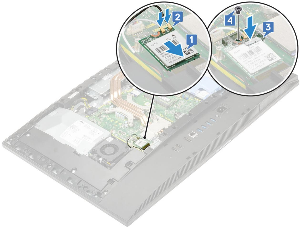
2 Untuk memasang pelindung kartu WLAN:
