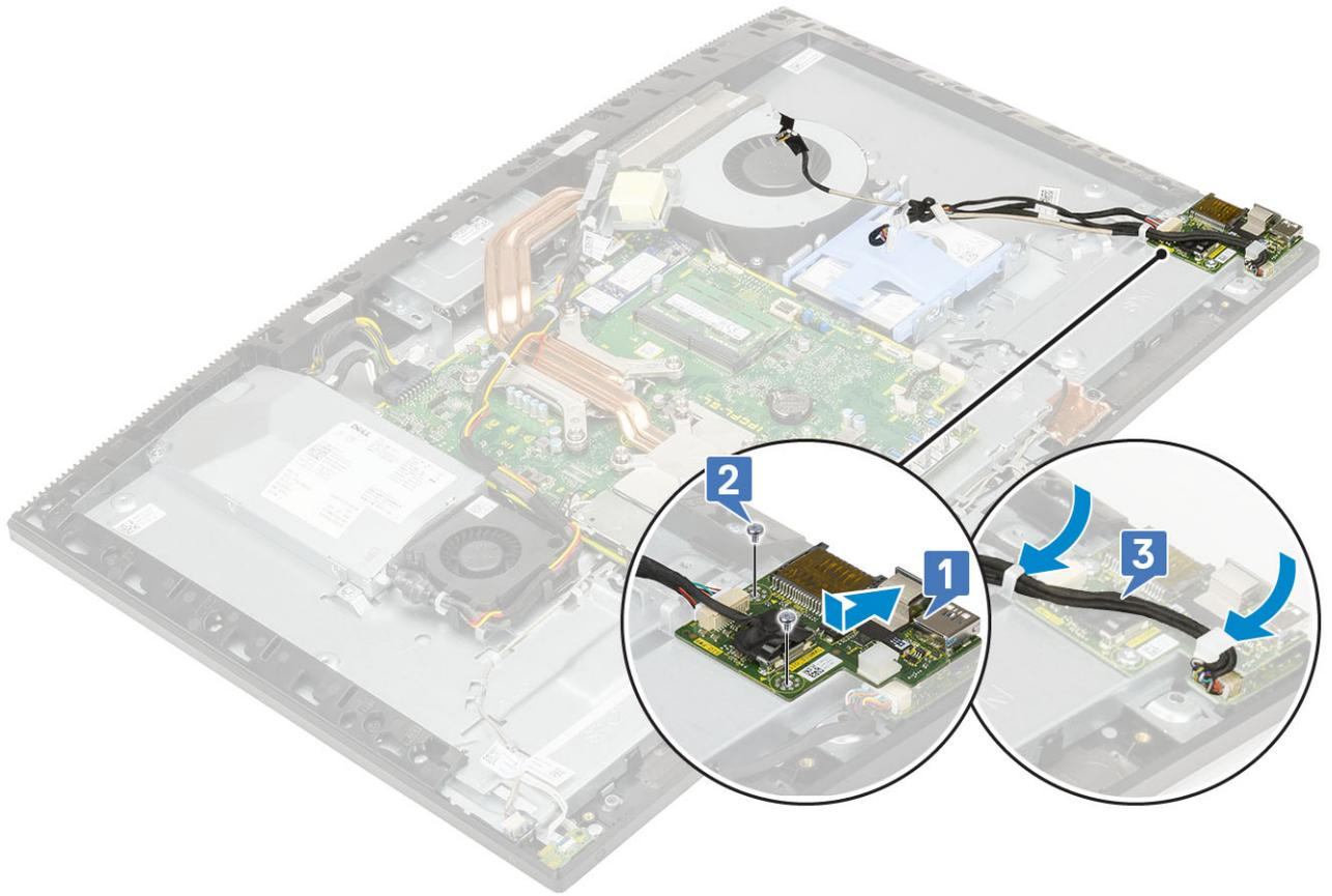
2 Untuk memasang kembali pelindung board I/O:
