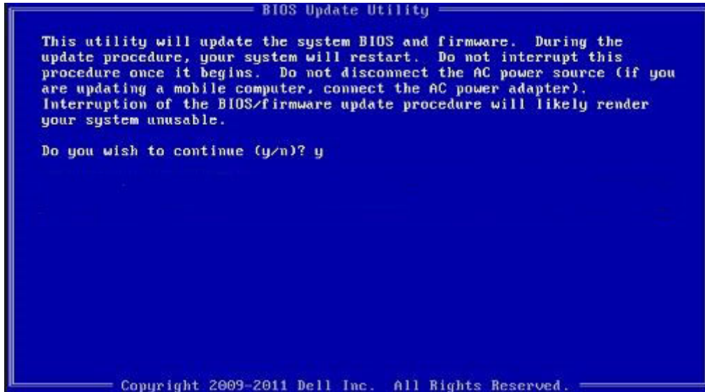
شكل 3. شاشة تحديث نظام الإدخال/الإخراج الأساسي (BIOS) عبر نظام تشغيل الأقراص (DOS)
